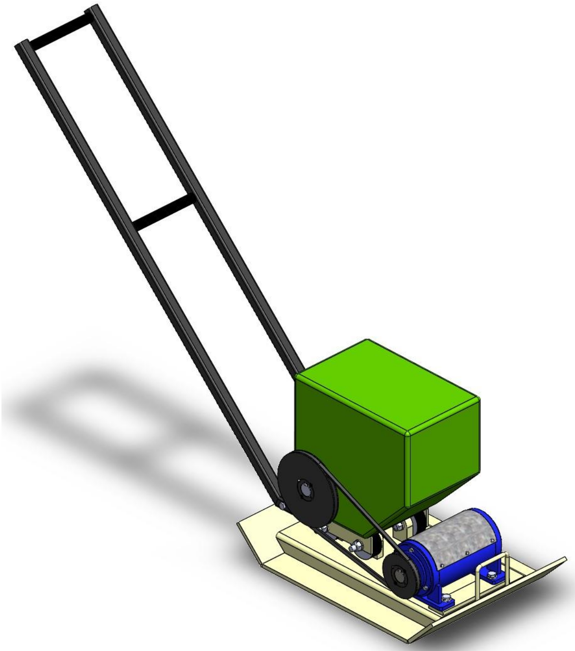
Slika 58 Računalni model vibracijskog stroja za nabijanje tla
