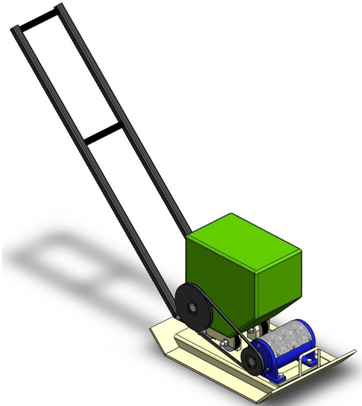
**Slika 58 Računalni model vibracijskog stroja za nabijanje tla**
