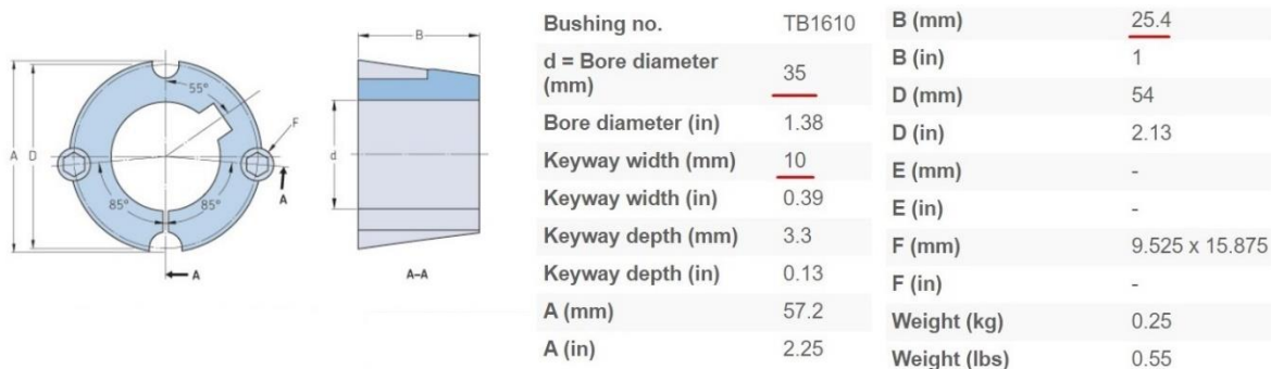
Slika 30 SKF stezna čahura PHF TB1610x35 [16]
