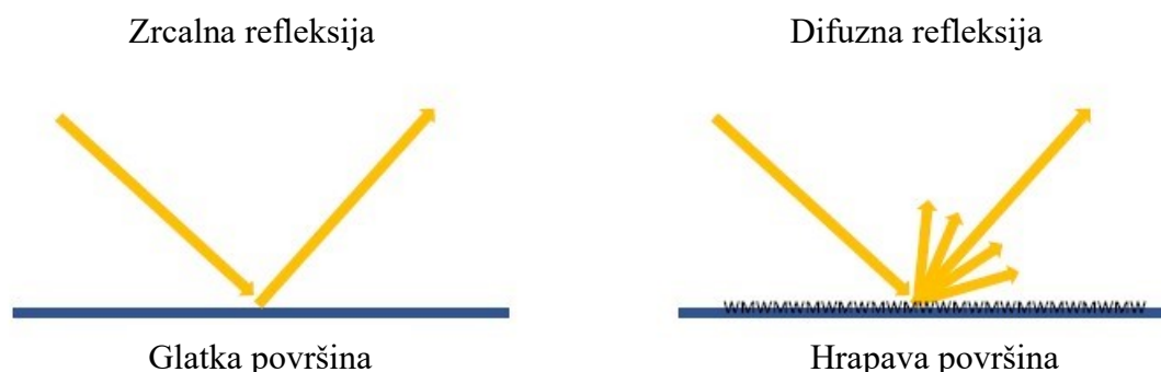
Slika 26. Shematski prikaz zrcalne i difuzne refleksije [36]
