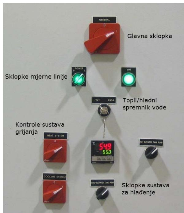
Slika 8.1 Ormarić sa prekidačima za pokretanje mjerne linije
