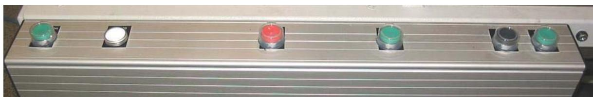
*Slika 8.3 Tipke za otvaranje i zatvaranje mjerne linije*
