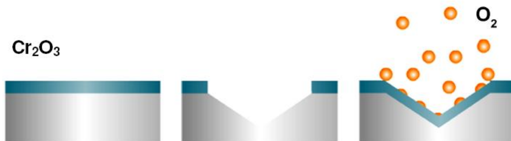
Slika 30. Prikaz mehanizma samoobnavljanja pasivnog filma kromovih oksida na površini [18]
