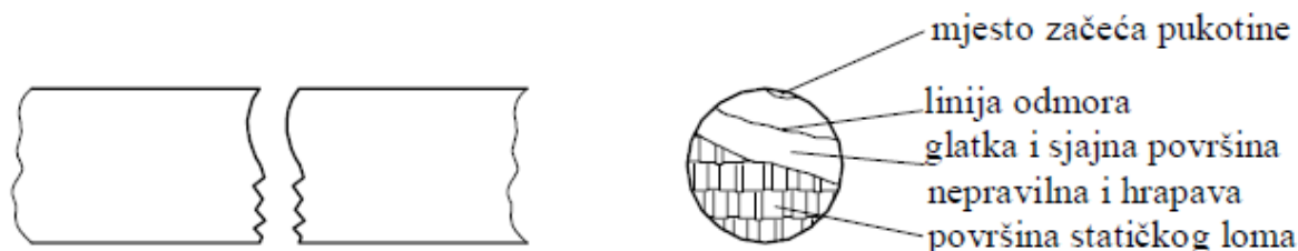
Slika 2.3 Opći izgled površine loma uslijed zamora materijala
