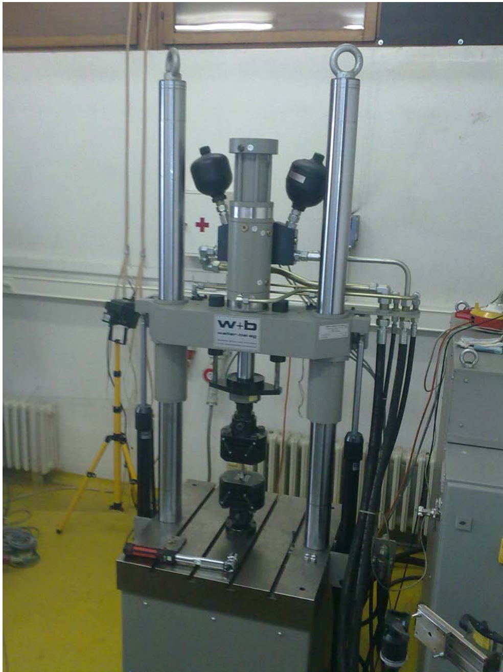
Slika 6.1 Servohidraulička umaralica LFV-50 HH
