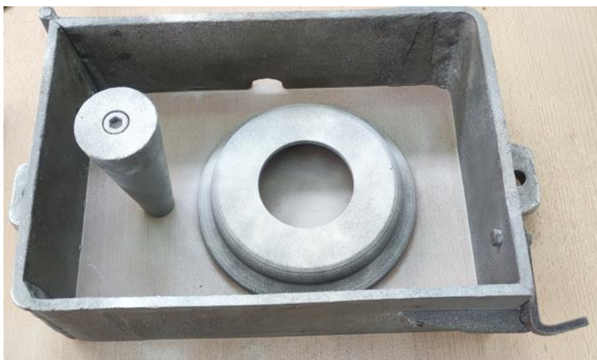
Slika 52. Smještanje modela odljevka i spusta u gornjak
