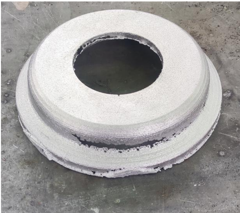
Slika 71. Greška u odljevku
