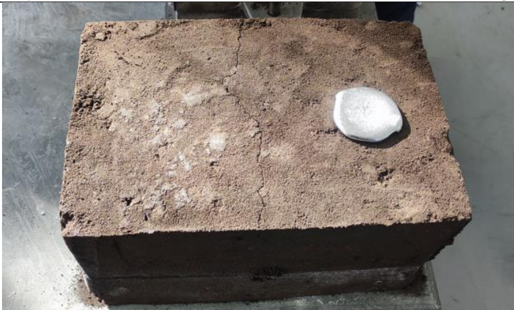
Slika 67. Izgled kalupa nakon skrućivanja
