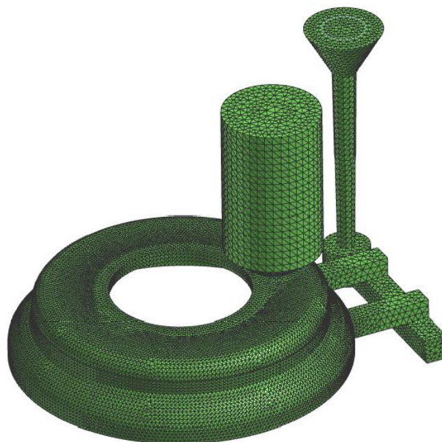
Slika 37. Mreža odljevka, uljavnog sustava i pojila
