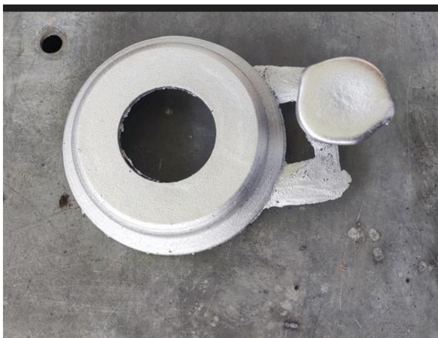
Slika 70. Odljevak s uljevnim sustavom
