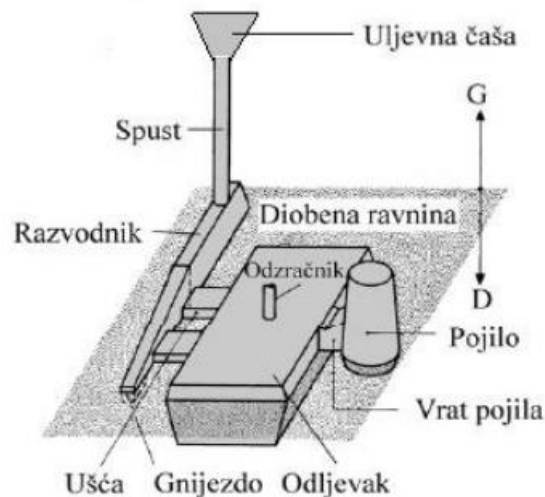
Slika 10. Uljevni sustav [4]
