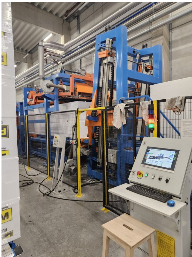
Slika 17. Automatizirani linijski stroj za rezanje i pakiranje
