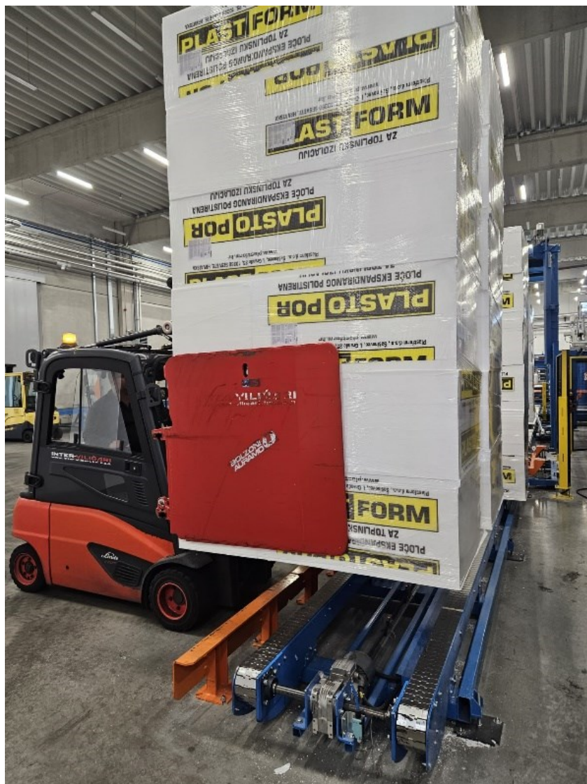
Slika 19. Transport gotovih proizvoda pomoću viličara sa stezaljkom
