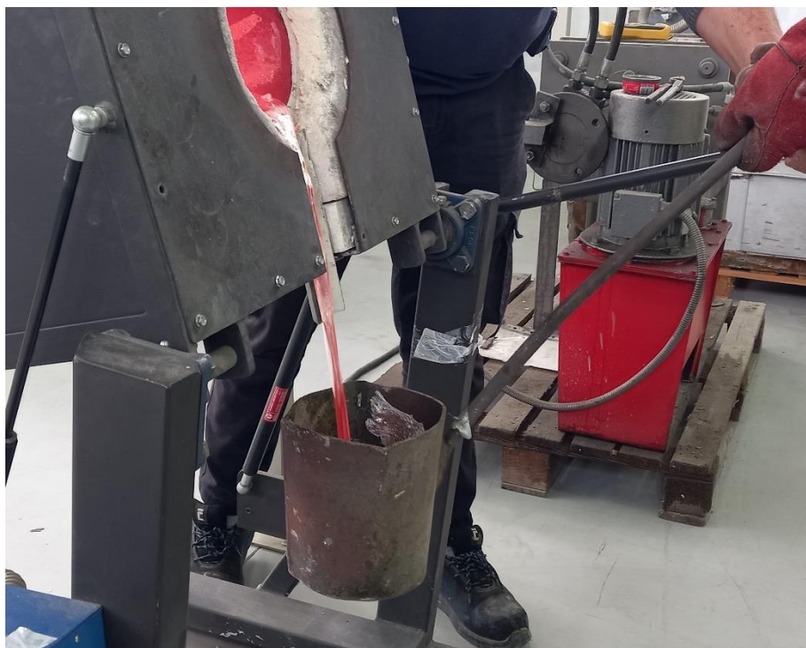
Slika 6.13 Izljevanje taljevine iz peći u uljevni lonac
