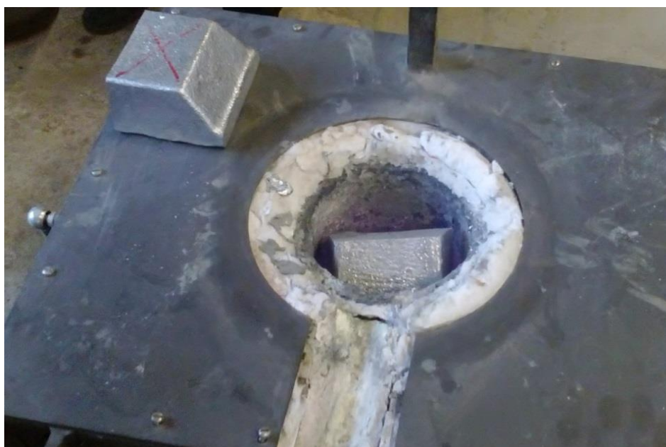
Slika 6.6 Taljenje aluminijskih ingota
