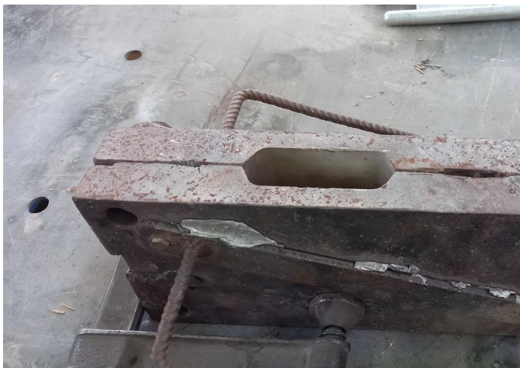
Slika 6.12 Kokila je stegnuta i spremna za uljevanje taljevine
