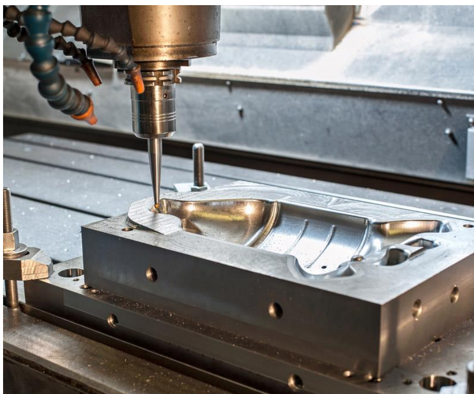
Slika 3.7 CNC obrada kalupne šupljine [18]
