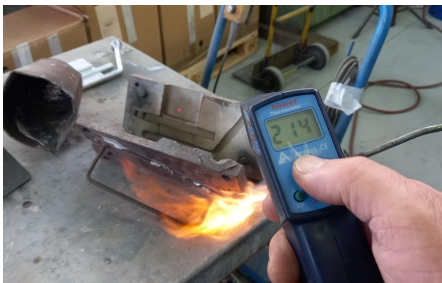
Slika 6.10 Mjerenje temperature (slikano za vrijeme zagrijavanja)
