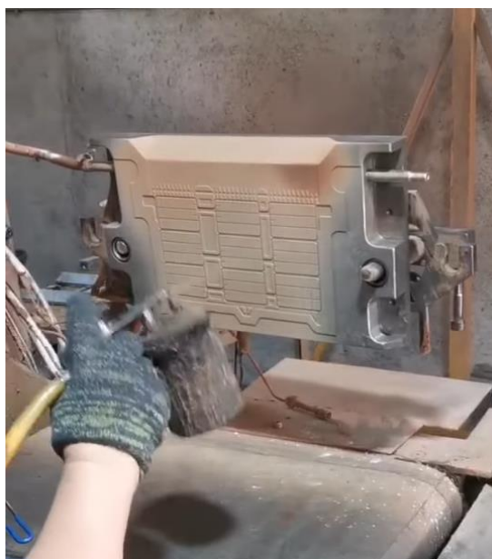
Slika 3.10 Nanošenje premaza zračnim prskanjem [17]
