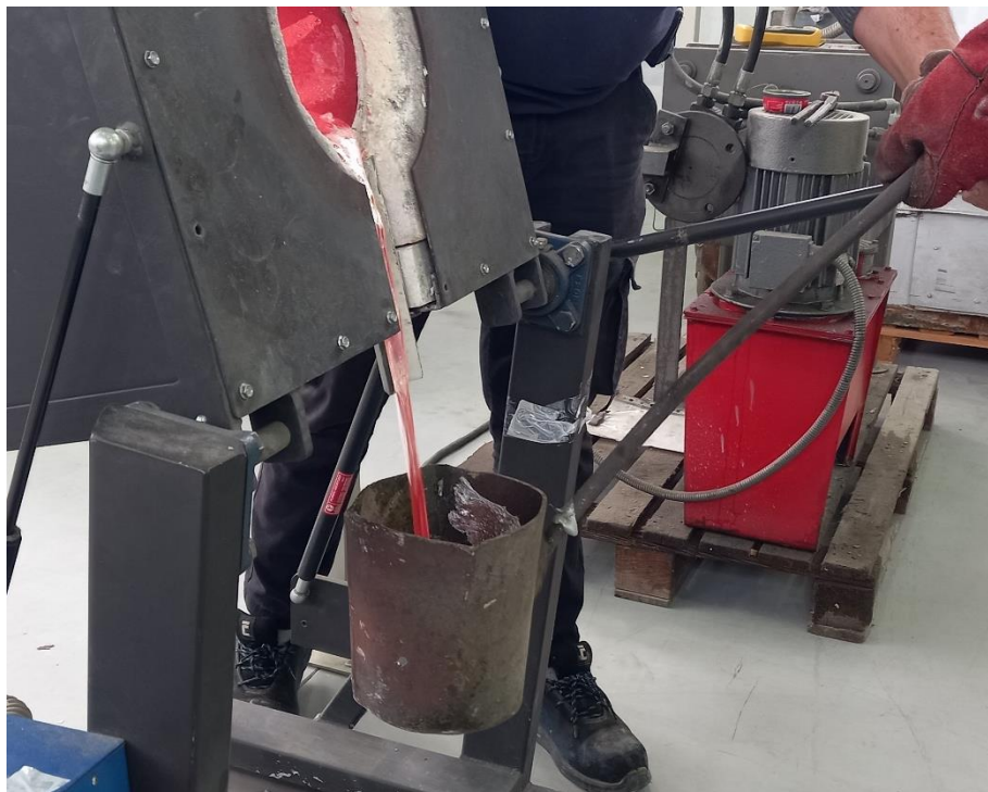
Slika 6.13 Izljevanje taljevine iz peći u uljevni lonac
