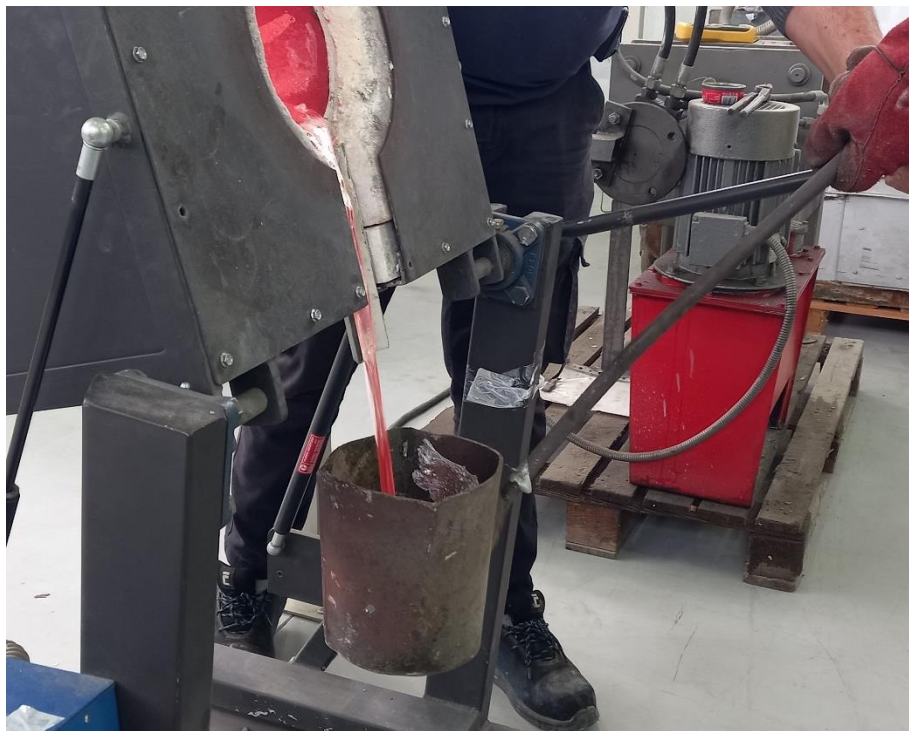
Slika 6.13 Izljevanje taljevine iz peći u uljevni lonac
