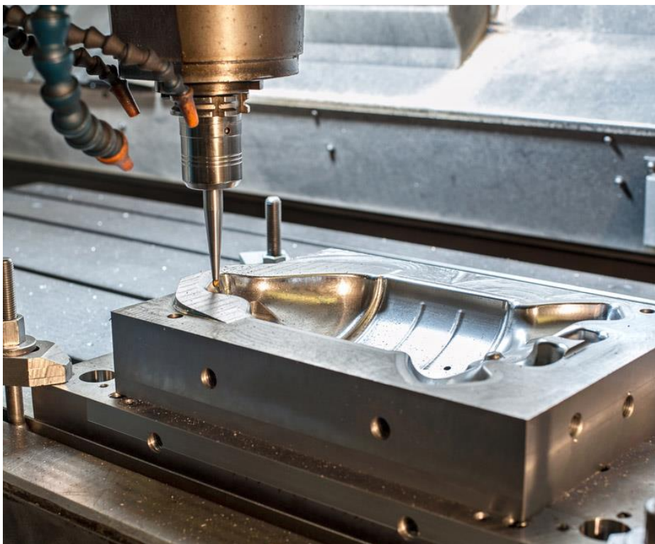
Slika 3.7 CNC obrada kalupne šupljine [18]
