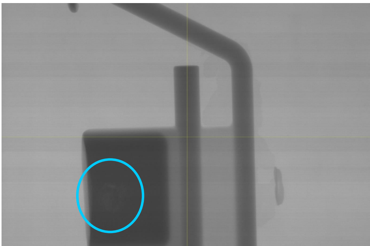
Slika 6.17 Radiogram odljevka s uljevnim sustavom
