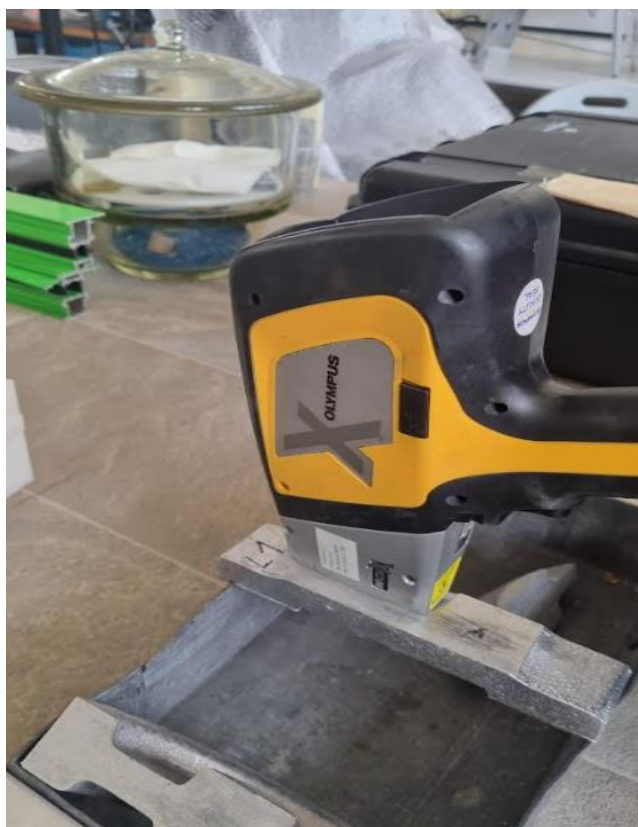
Slika 6.18 Određivanje kemijskog sastava odljevka XRF metodom
