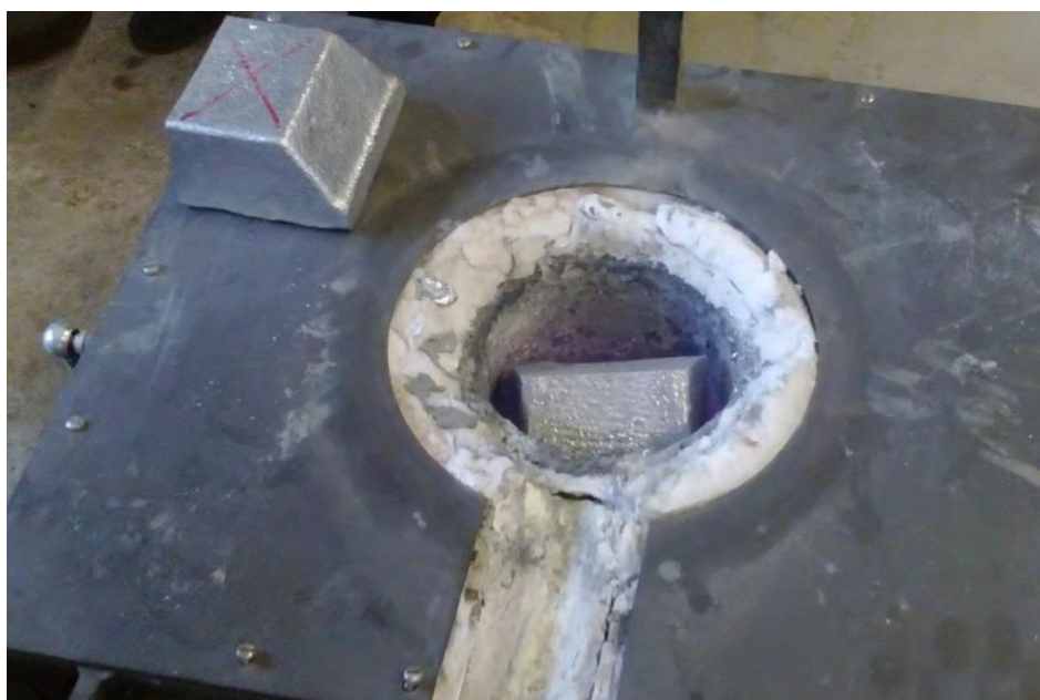
Slika 6.6 Taljenje aluminijskih ingota
