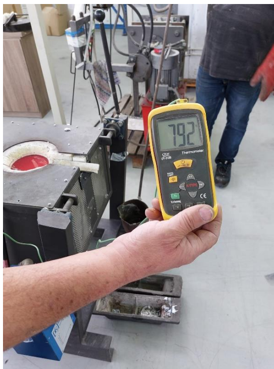
Slika 42. Postignuta temperatura taline u peći
