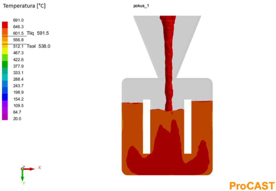
Slika 25. Nastavak punjenja kokile i početak hlađenja taline
