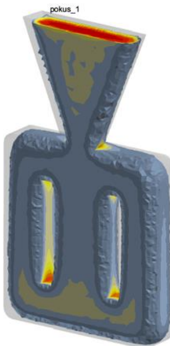
Slika 29. Potpuno skrućivanje rubnih dijelova taline
