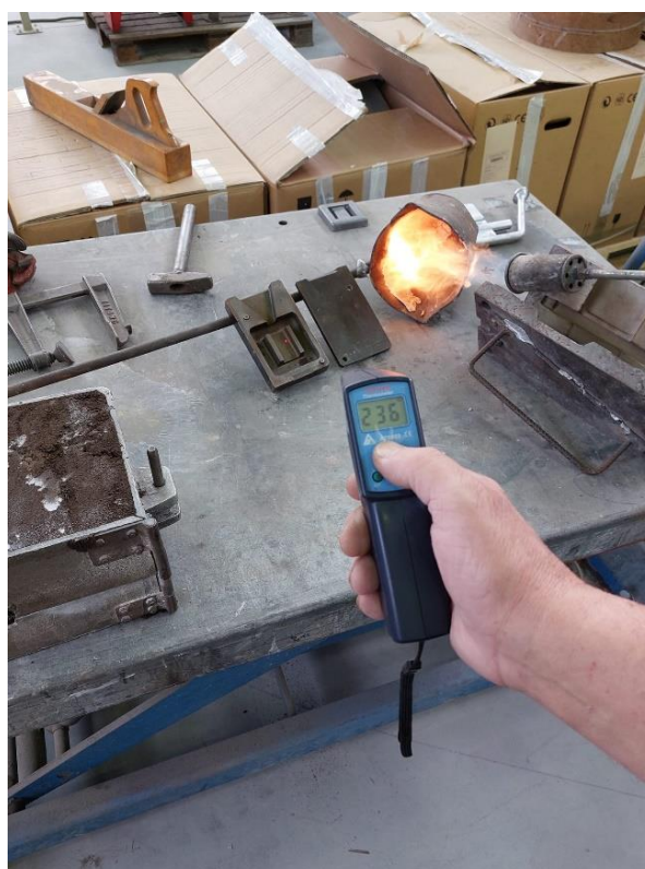
Slika 39. Postignuta temperatura kokile
