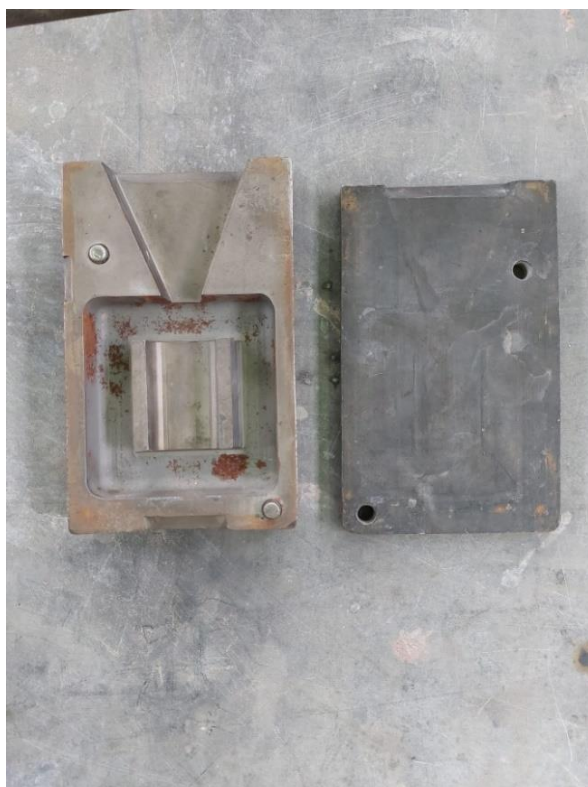
Slika 37. Kokila korištena za lijevanje
