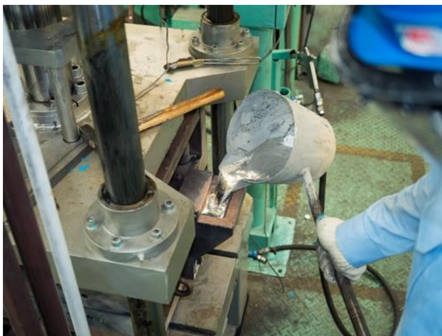
Slika 7. Ručno ulijevanje rastaljenog metala u kalupnu šupljinu [16]
