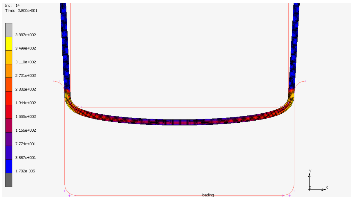
Slika 31. Naprezanja u limu tijekom procesa oblikovanja
