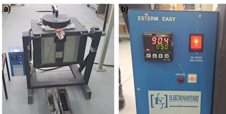
Slika 69. Taljenje: a) peć, b) temperatura peći
