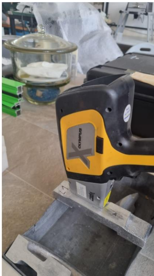
Slika 78. Određivanje kemijskog sastava odljevka XRF metodom
