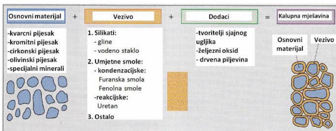
Slika 8. Sastav kalupne mješavine [3]
