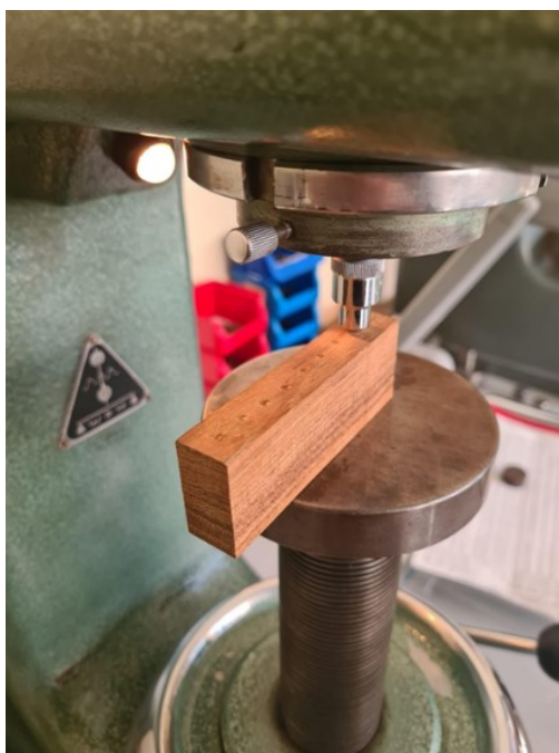
Slika 16. Ispitivanje tvrdoće tikovine
