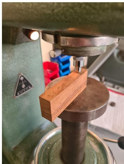
Slika 16. Ispitivanje tvrdoće tikovine
