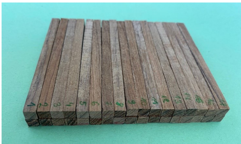
Slika 41. Uzorci s kutom između sile i goda od 45^\circ
