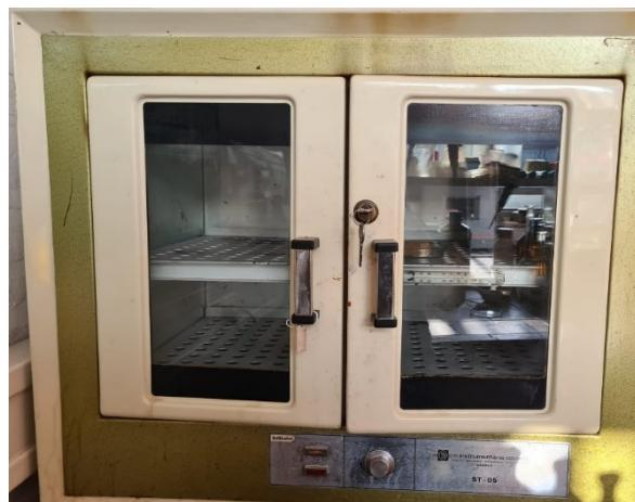
Slika 32. Sušionik u kojem je sušen uzorak
