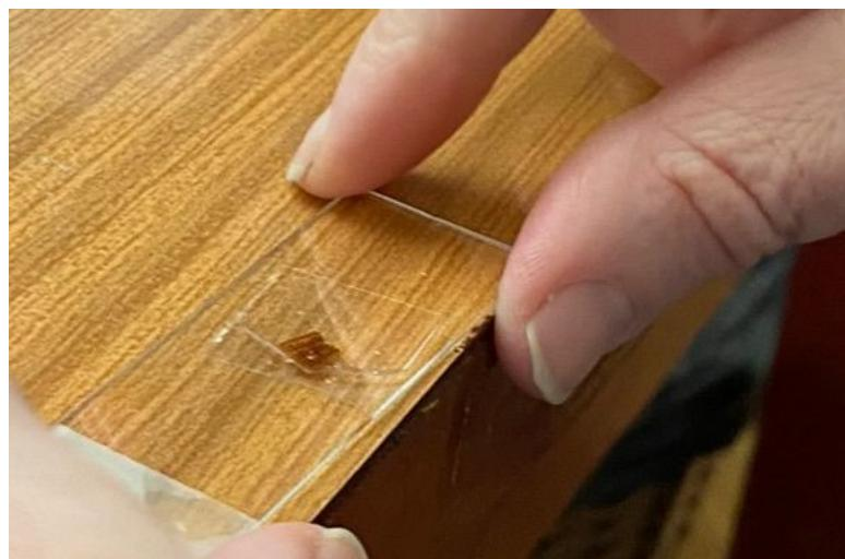
**Slika 26.** Vrlo tanak uzorak za ispitivanje mikrostrukture
