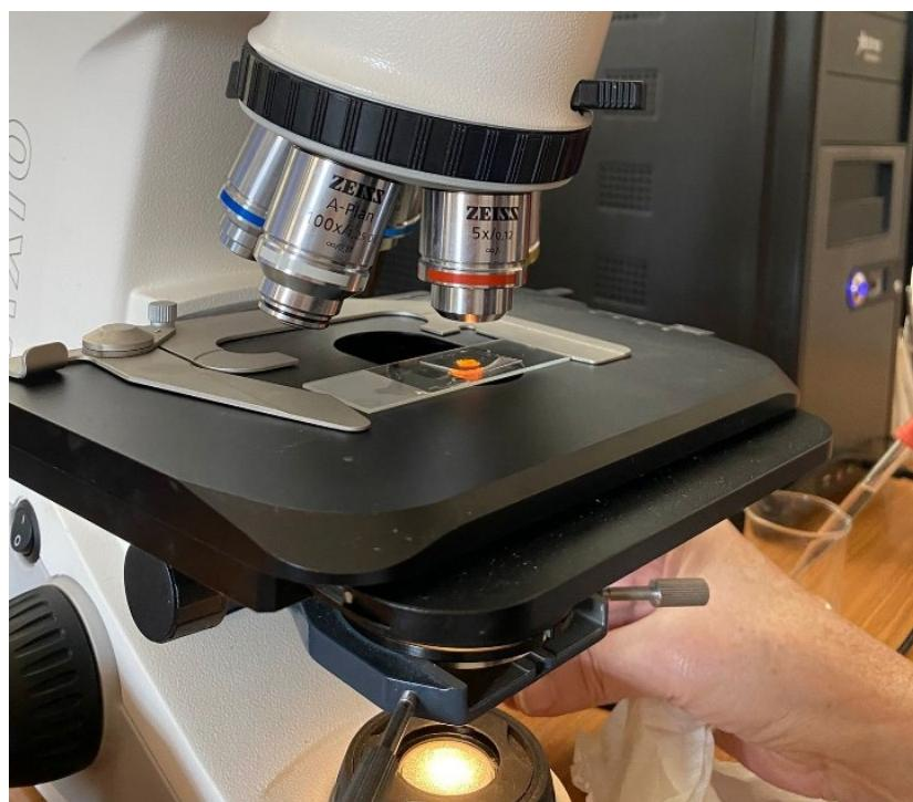
**Slika 27.** Ispitivanje mikrostrukture tikovine
