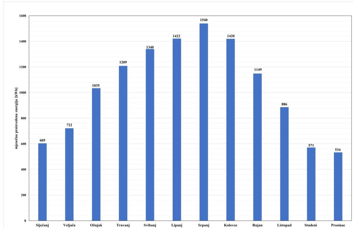
**Slika 9. Godišnja proizvodnja električne energije fotonaponskom elektranom**
