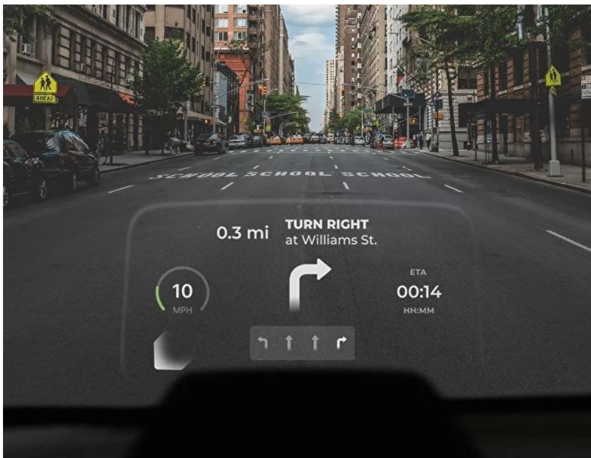
Slika 7. Izvedba proširene stvarnosti transparentnih zaslonom Hudway za automobile [14]
