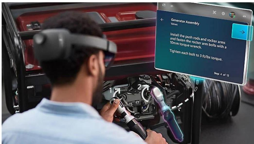
**Slika 16. Primjena HoloLens 2 u proizvodnji [15]**
