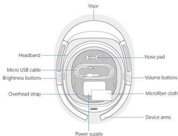
**Slika 8. Osnovni dijelovi naočala i dodaci [13]**
