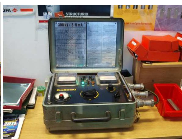
Slika 28. Upravljačka jedinica radiografskog uređaja – FSB
