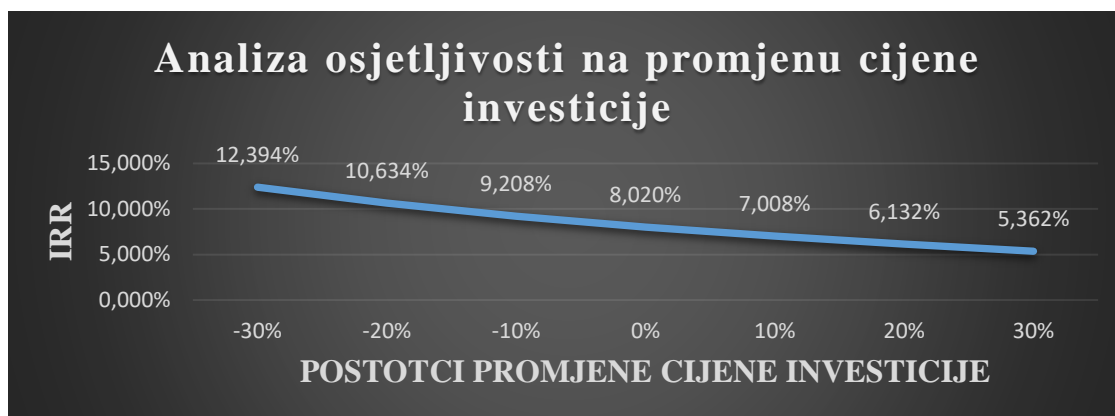
Dijagram 2. Analiza osjetljivosti ekonomske isplativosti fiksne odobalne vjetroelektrane na promjenu cijene investicije
