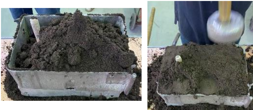
Slika 59. Nasipavanje kalupne mješavine i sabijanje
