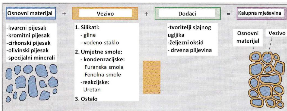
Slika 5. Sastav kalupne mješavine [2]
