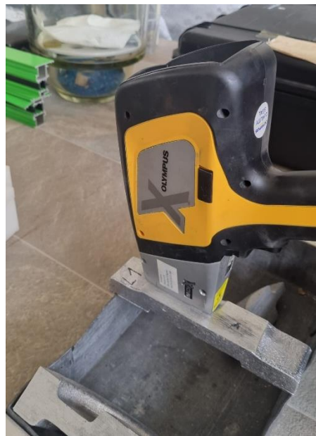
Slika 75. Određivanje kemijskog sastava odljevka XRF metodom
