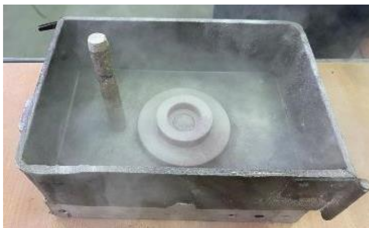
Slika 56. Postavljanje modela i spusta u gornji dio kalupa
