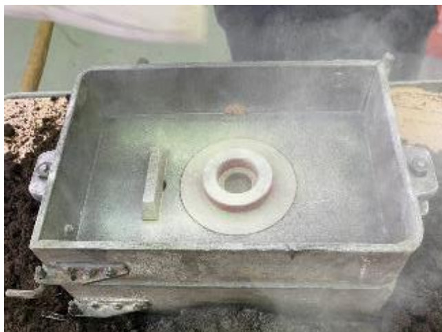
Slika 61. Postavljanje donjeg dijela kalupa i modela razvodnika
