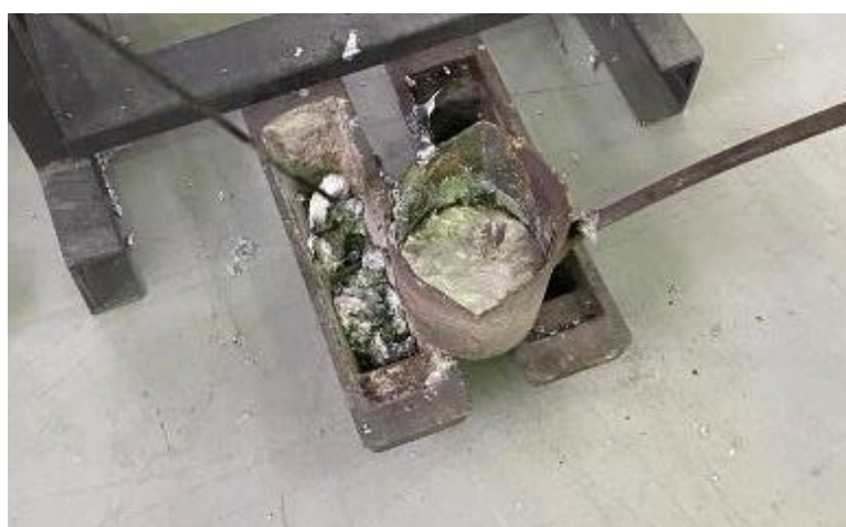
Slika 68. Uklanjanje sloja oksida sa površine taljevine
