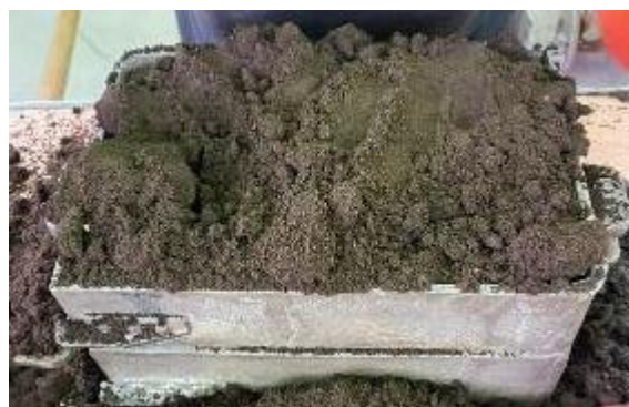
Slika 62. Nasipavanje modelne i punidbene kalupne mješavine
