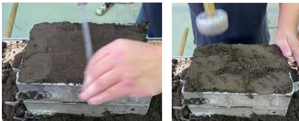
Slika 63. Sabijanje i uklanjanje viška kalupne mješavine
