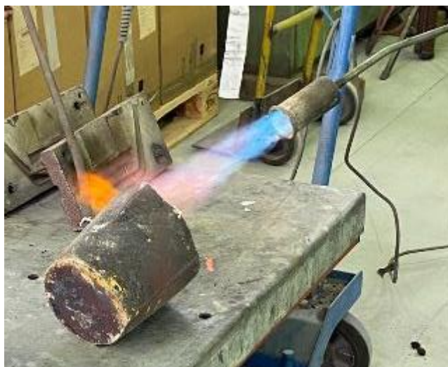
Slika 65. Zagrijavanje lonca plinskim plamenom
