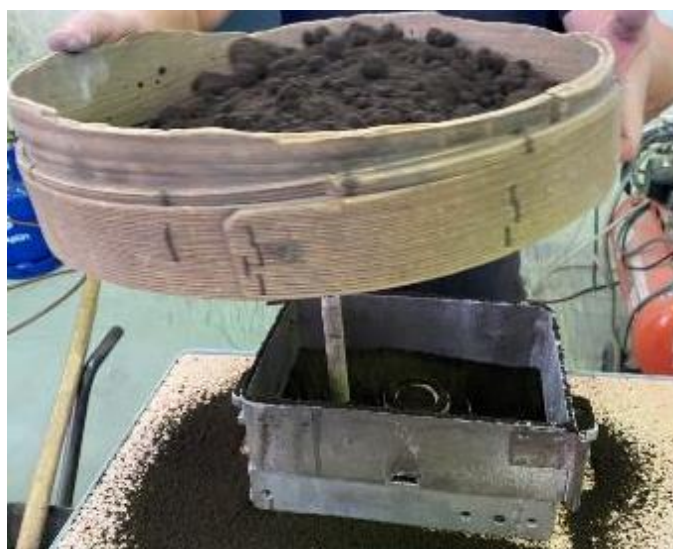
Slika 57. Nasipavanje modelnog pijeska
