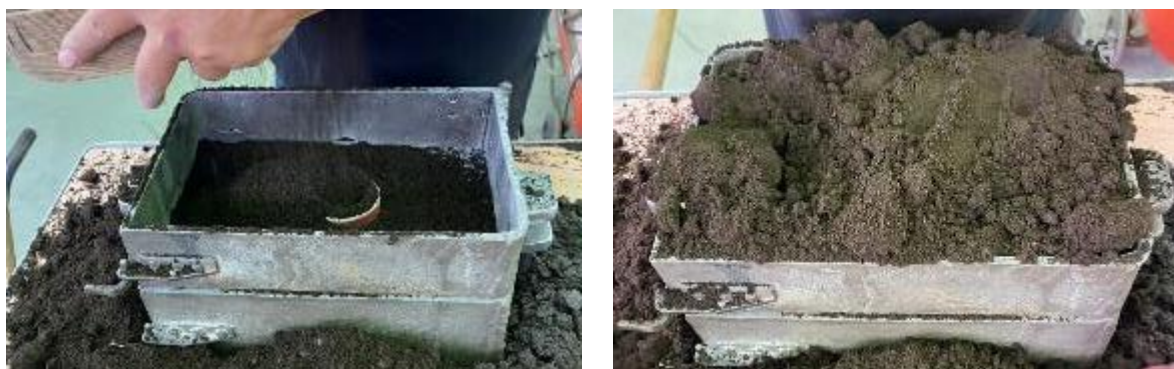
Slika 62. Nasipavanje modelne i punidbene kalupne mješavine
