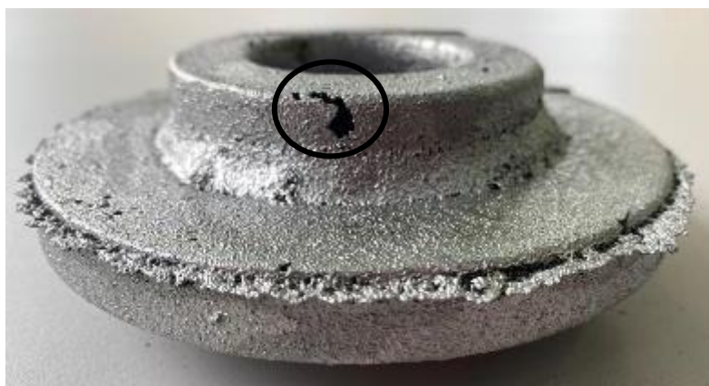
Slika 73. Poroznost na odljevku
