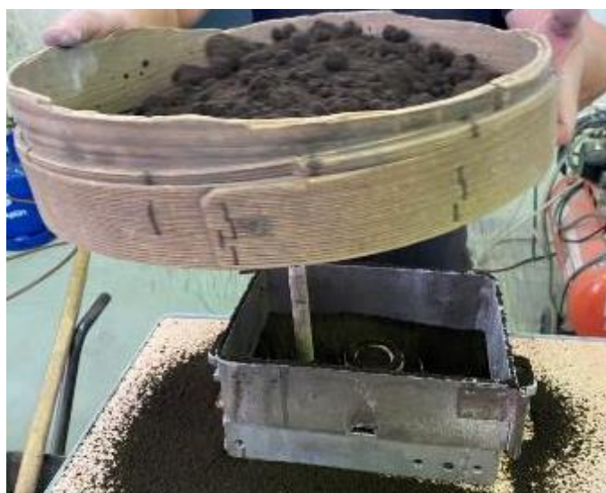
Slika 57. Nasipavanje modelnog pijeska
