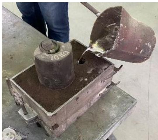
Slika 69. Uljevanje taljevine u kalup
