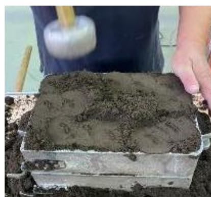
Slika 63. Sabijanje i uklanjanje viška kalupne mješavine
