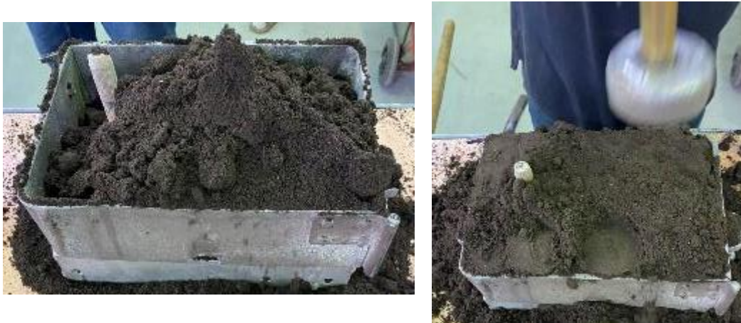
Slika 59. Nasipavanje kalupne mješavine i sabijanje
