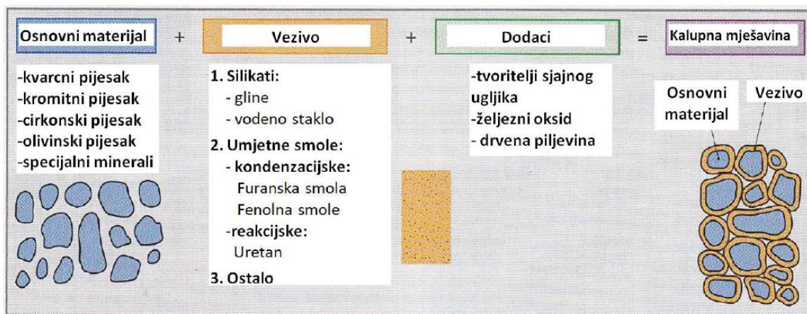
Slika 5. Sastav kalupne mješavine [2]
