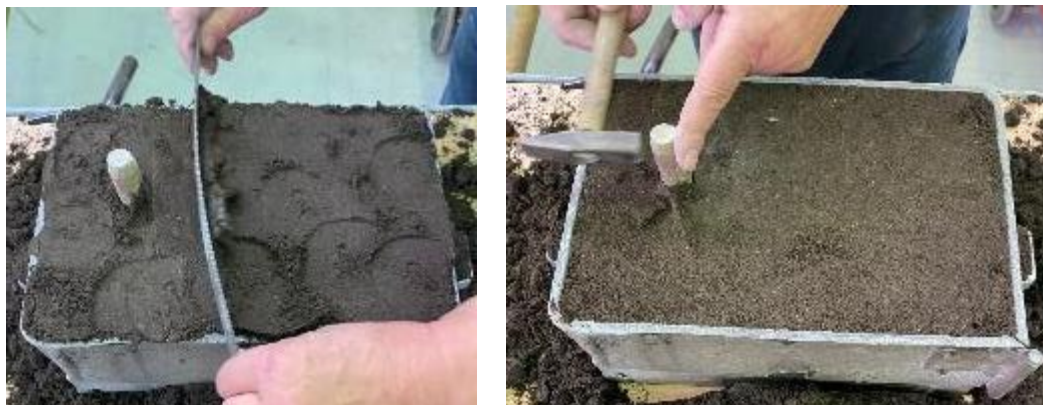
Slika 60. Uklanjanje viška kalupne mješavine i vađenje spusta
