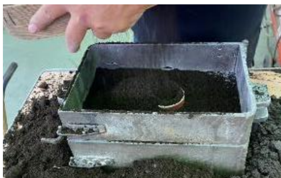
Slika 62. Nasipavanje modelne i punidbene kalupne mješavine
