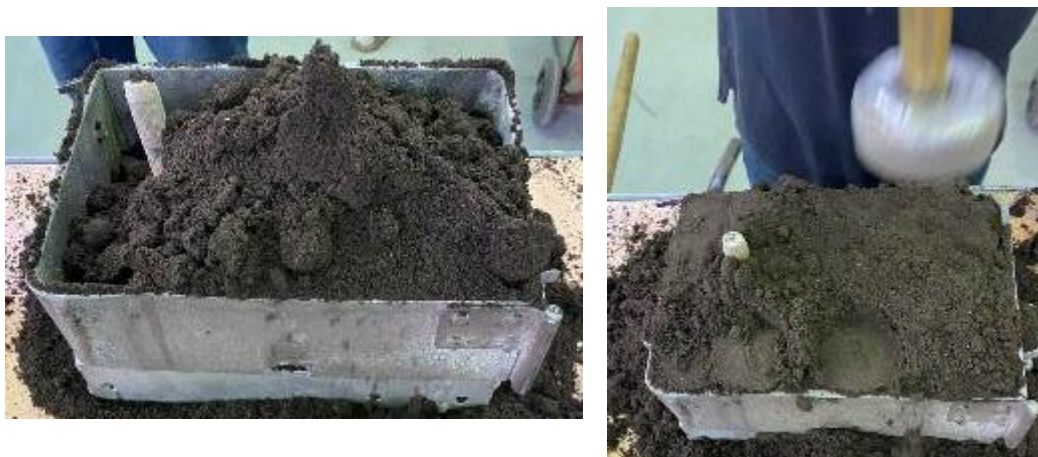
Slika 59. Nasipavanje kalupne mješavine i sabijanje
