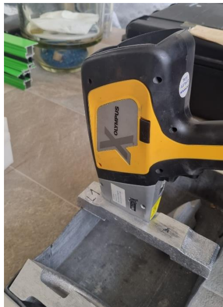
Slika 75. Određivanje kemijskog sastava odljevka XRF metodom
