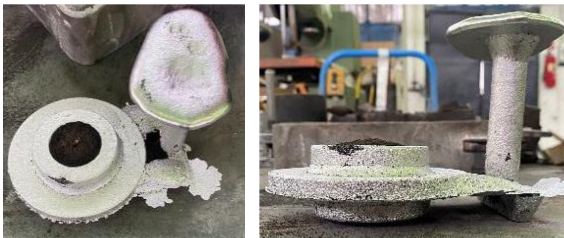
Slika 71. Odljevak s uljevnim sustavom
