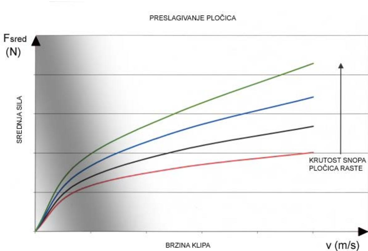
**Slika 3.2** Preslagivanje pločica
