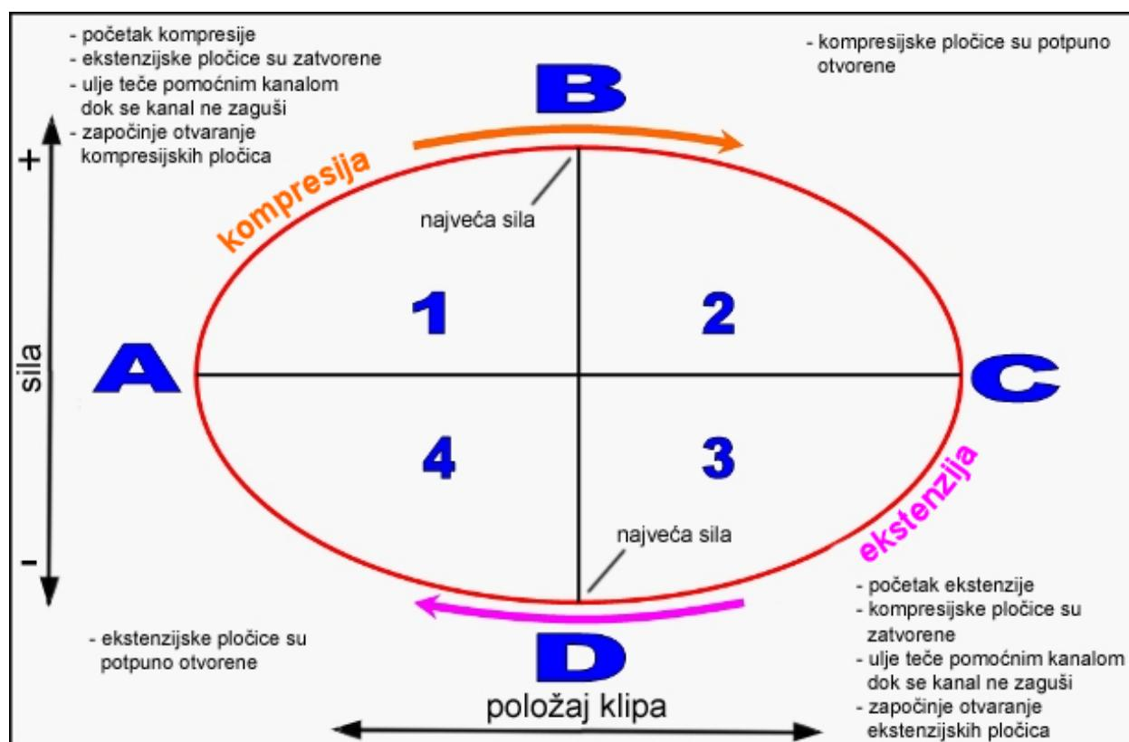
Dijagram prigušna sila – položaj klipa, prikazuje pojave u prigušivaču za neki položaj klipa, slika 2.1. Na njemu se vide promjene sile uzrokovane otvaranjem i zatvaranjem pločica (slika 2.2), zagušenjem pomoćnih kanala, zaglavljivanjem brtvi, kavitacijom ulja itd. Koristan je za analizu stanja prigušivača, ali nije prikladan u svrhu namještanja prigušne sile, jer u tu svrhu prikladnije poznavanje prigušne sile kao funkcije brzine, a ne položaja.
