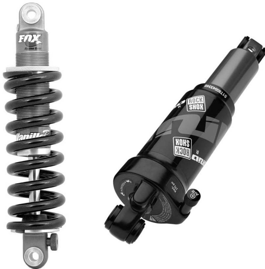
Slika 4.1. Amortizeri sa spiralnom oprugom i zračnom oprugom
