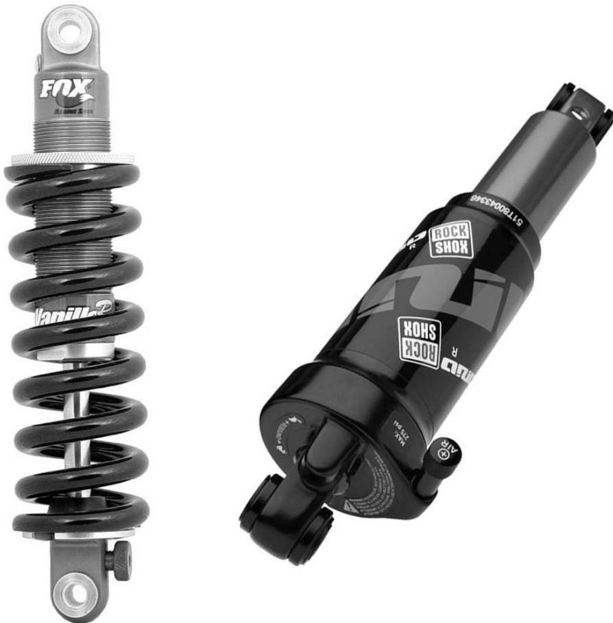
**Slika 4.1.** Amortizeri sa spiralnom oprugom i zračnom oprugom
