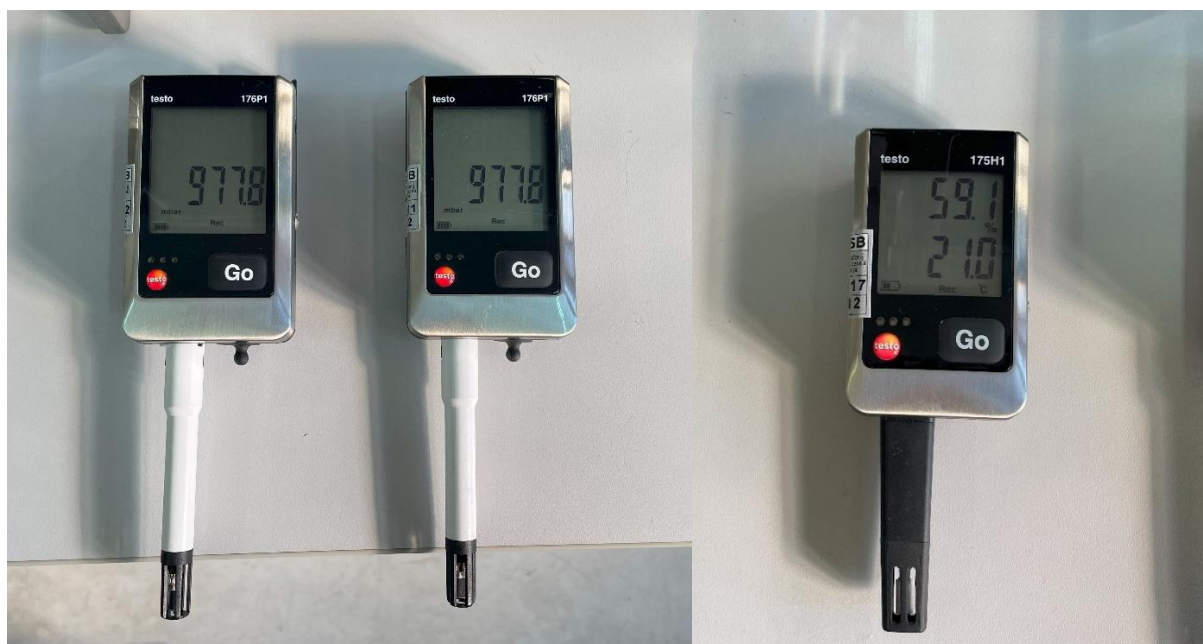
Slika 25. Ispitivani barometri marke Testo 176P1(lijevo) i uređaj za mjerenje temperature i vlage zraka Testo 175H1(desno)
