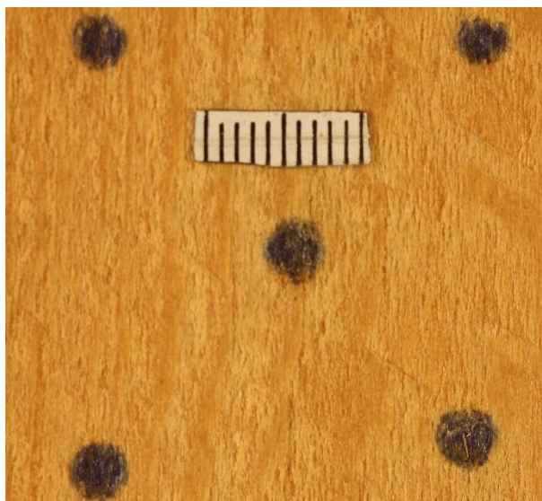
Slika 32. Otisci kuglice pri mjerenju tvrdoće
