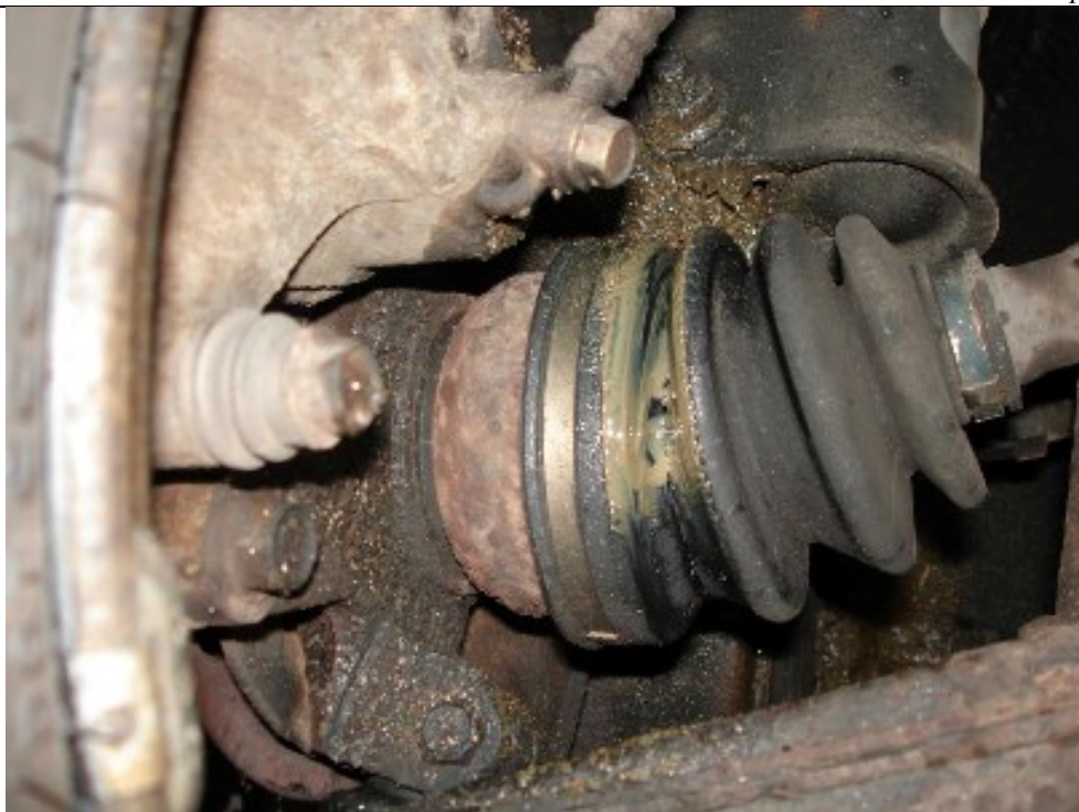
Slika 19. Kvar uzrokovan lomom manžete i curenjem masti za podmazivanje ležaja [42]
