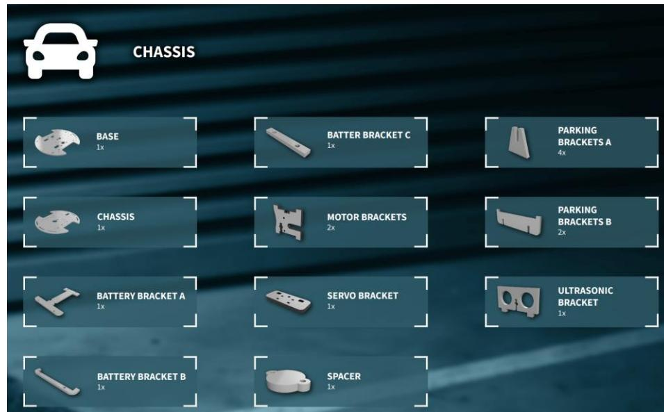
Slika 34. Dijelovi šasije robotskog vozila[30]
