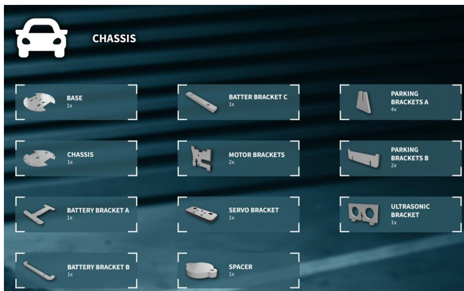
Slika 34. Dijelovi šasije robotskog vozila[30]
