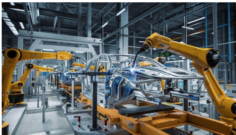
Slika 19. Automatizirani proces zavarivanja uporabom robota[25]
