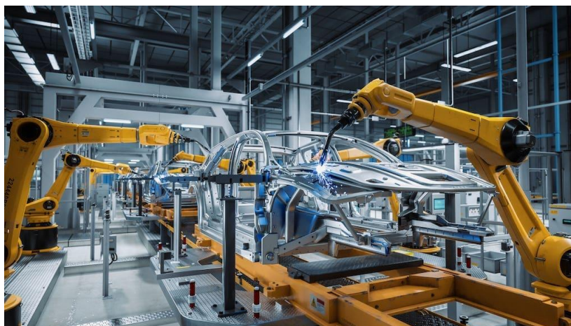
Slika 19. Automatizirani proces zavarivanja uporabom robota[25]
