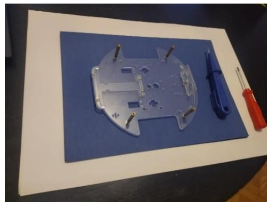
Slika 25. Montiranje nosača ultrazvučnog senzora i nosača baterije
