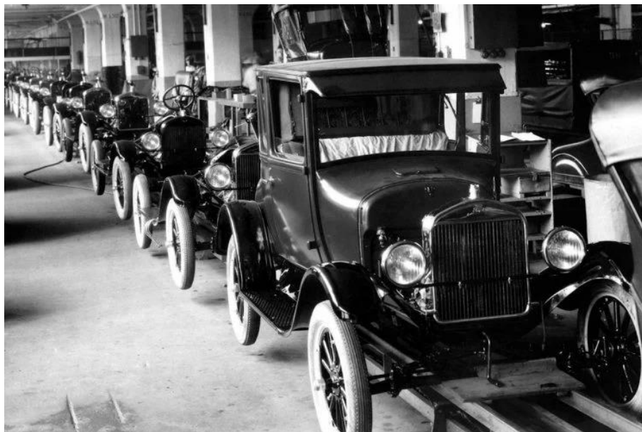
Slika 2. Pokretna linija za automobil Ford T [5]
