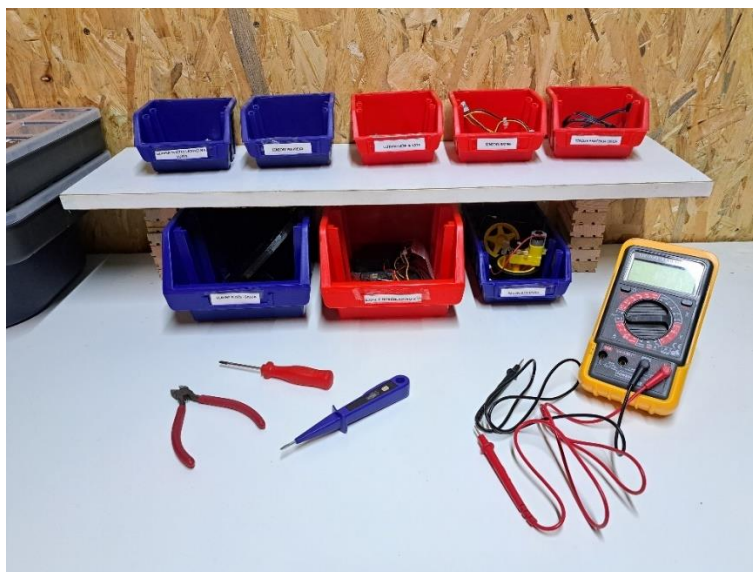
Slika 53. Sortiranje komponenti i alata korištenjem 5S-a
