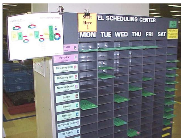
Slika 14. kanban kartice u proizvodnom procesu[10]
