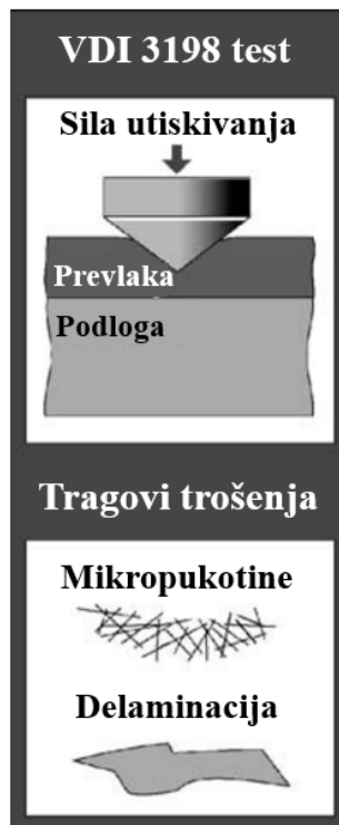
Slika 45 Metoda ispitivanja prionljivosti prevlake prema normi VDI 3198:2003 [42]
