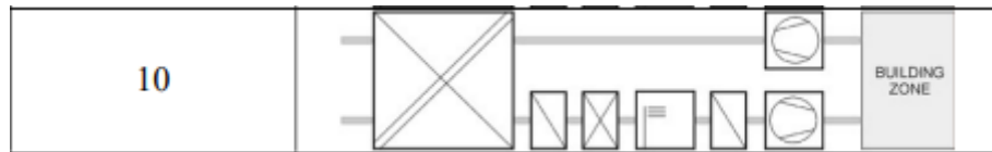
Slika 17. Varijanta klimatizacijskog sustava s rekuperatorom, grijačem, hladnjakom, parnim ovlaživačem i dogrijačem (shema 10)
