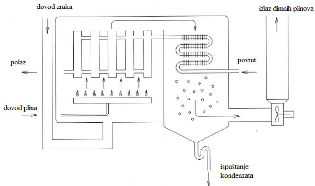
Slika 4.7. Shema plinskog kondenzacijskog kotla s atmosferskim plamenikom
