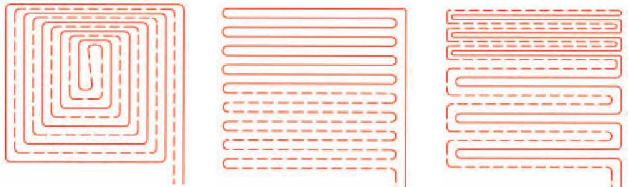
Slika 1.2. Pužna petlja, jednostruki meandar, dvostruki meandar
