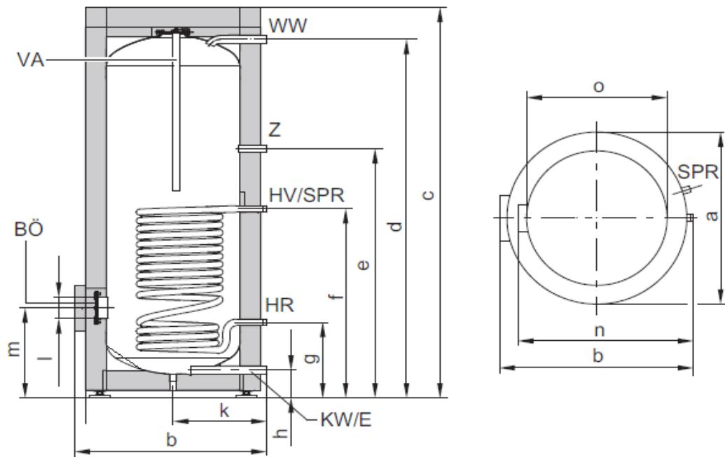
BÖ Otvor za nadzor i čišćenje
