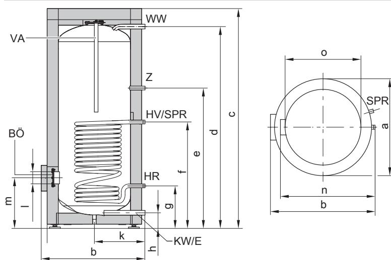
BÖ Otvor za nadzor i čišćenje
