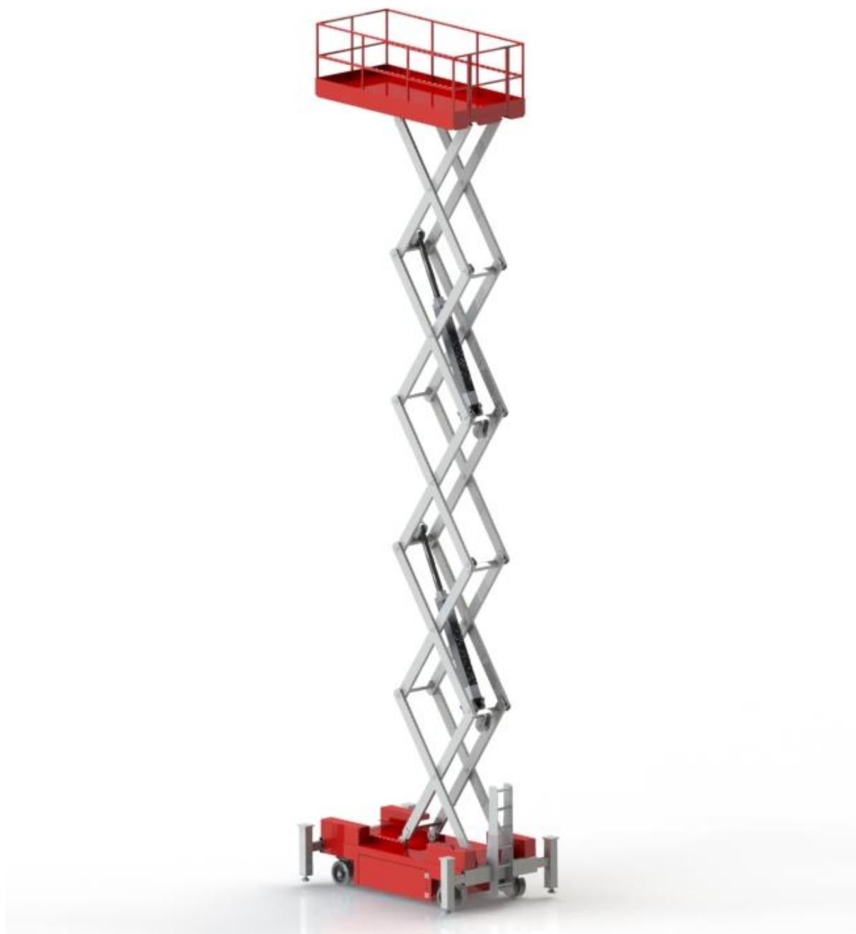
Slika 83. Prikaz podignute škaraste platforme
