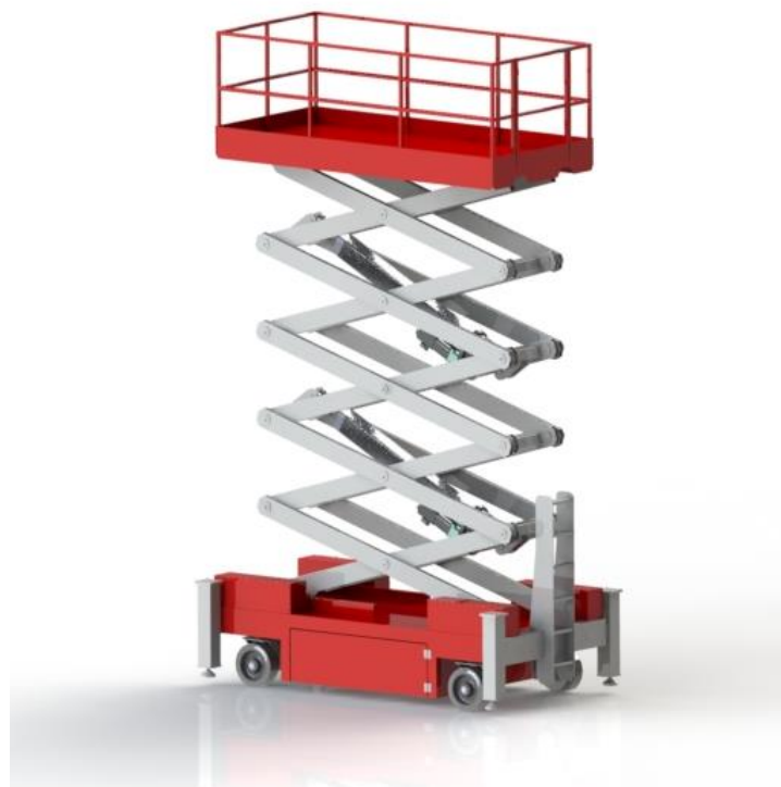
Slika 85. Škarasta platforma - render
