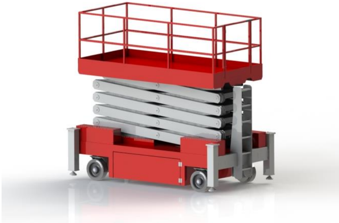
Slika 84. Prikaz spuštene škaraste platforme
