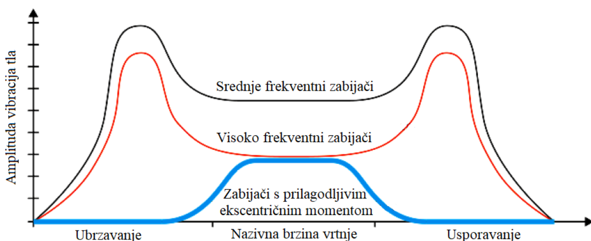
Slika 9. Dijagram amplitude vibracija tla ovisno o fazi rada vibracijskog zabijača [16]
