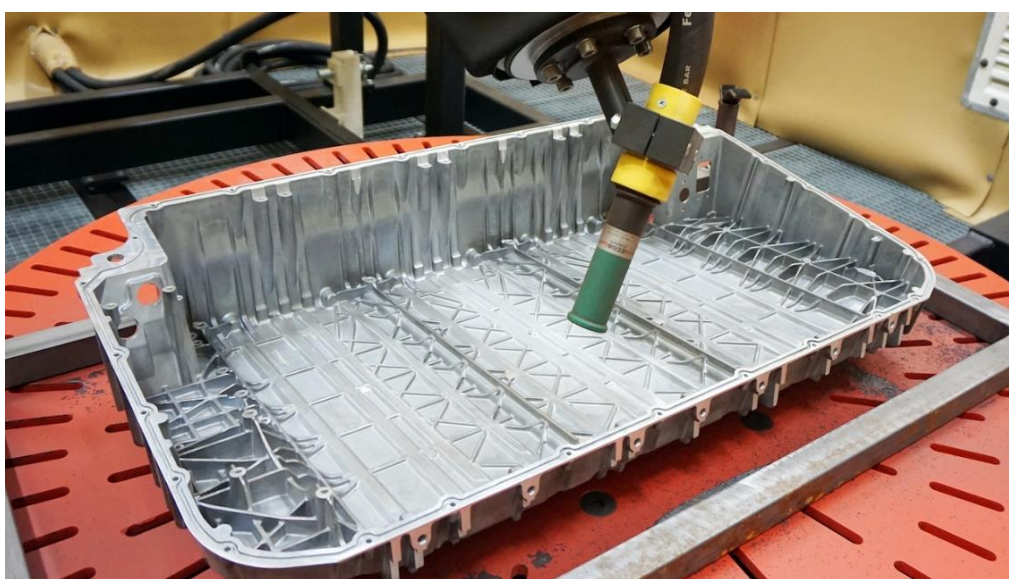
Slika 21 Automatizirani "Shot peening" dijelova za automobilsku industriju [10]
