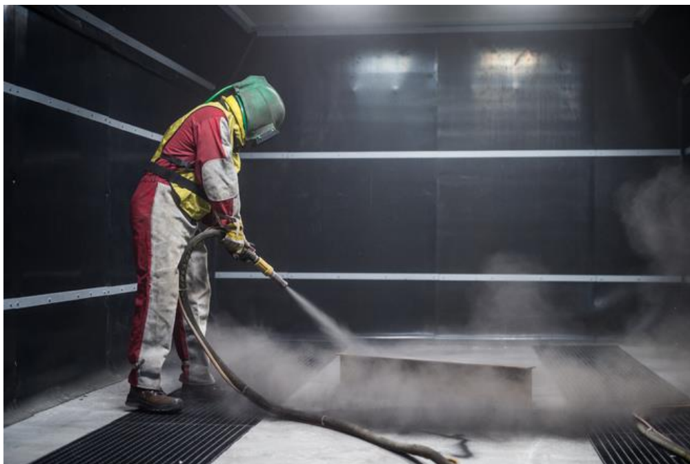
Slika 17 Proces sačmarenja komprimiranim zrakom [9]
