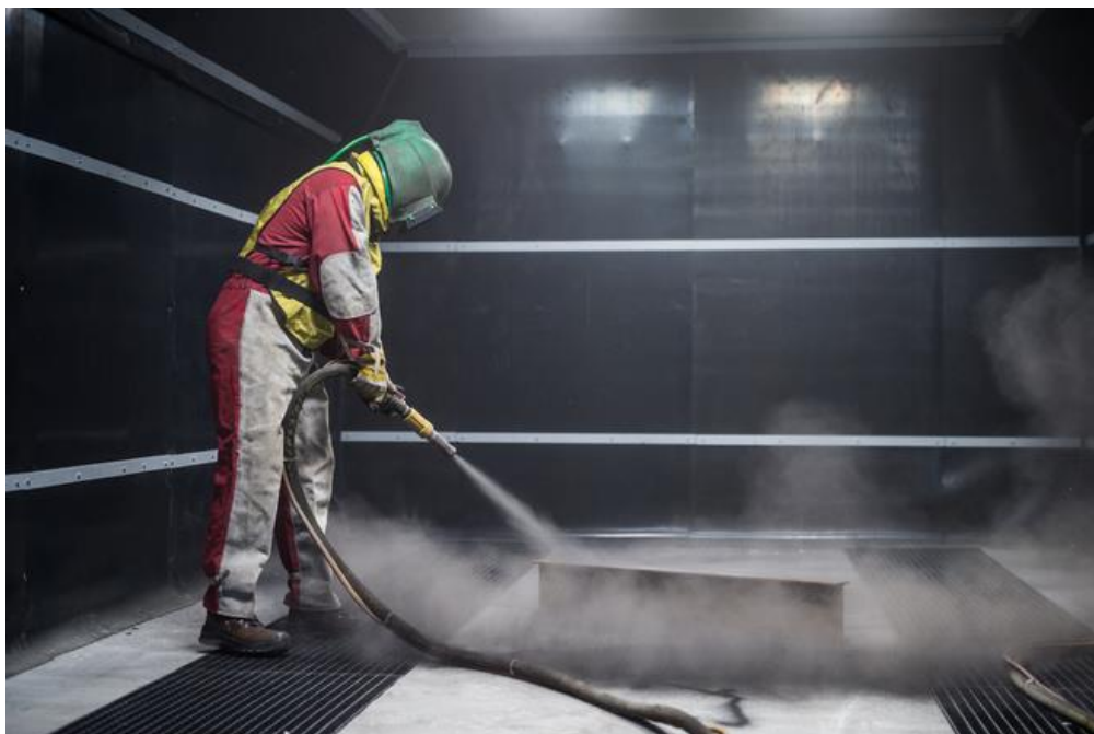
Slika 17 Proces sačmarenja komprimiranim zrakom [9]
