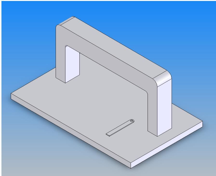
Slika 31. Položaj Hallove sonde kod mjerena normalne komponente konstrukcijskog čelika
