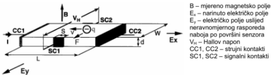
Slika 20. Princip rada Hallovog generatora [4]
