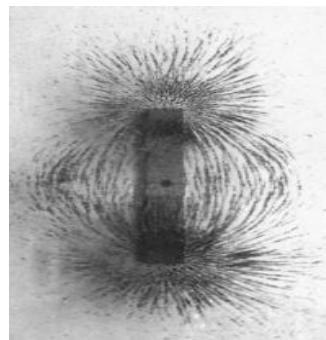
Slika 3. Željezna piljevina na staklenoj ploči (ispod magnet) [6]
