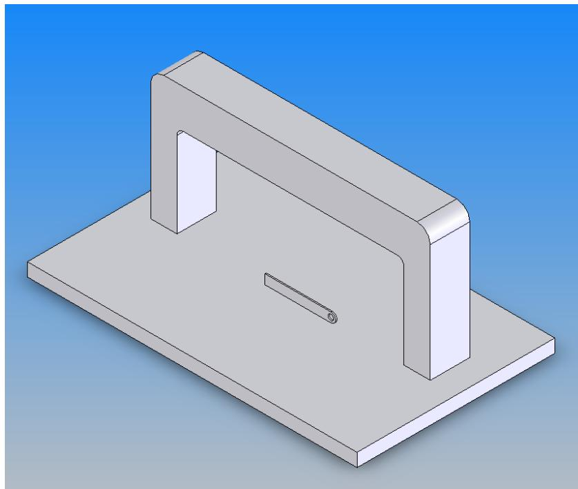
Slika 29. Položaj Hallove sonde kod mjerena tangencijalne komponente magnetskog polja
