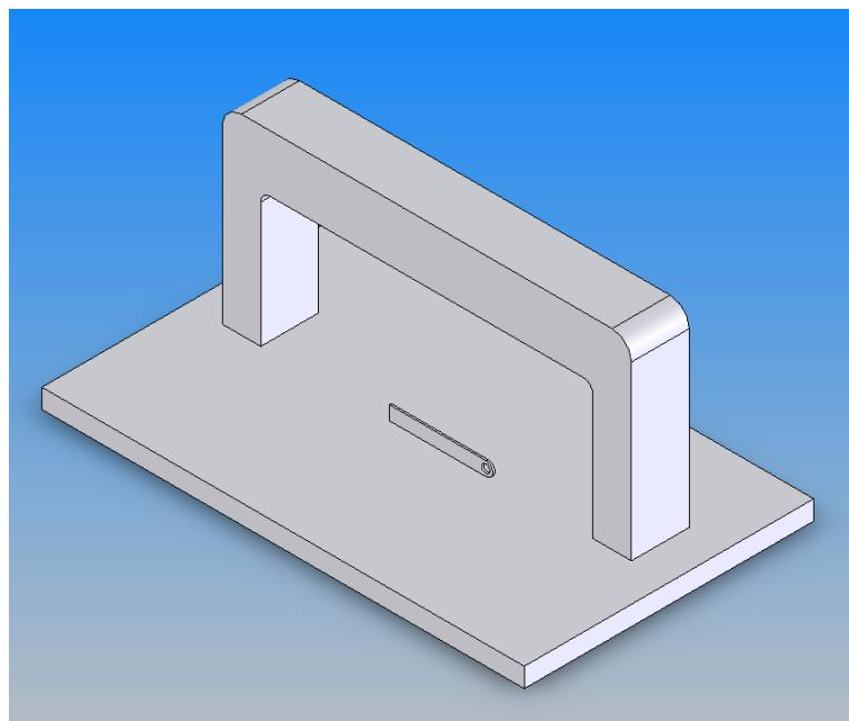
Slika 32. Položaj Hallove sonde kod mjerjenja tangencijalne komponente magnetskog polja konstrukcijskog čelika
