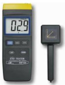
Slika 18. Trodimenzionalni mjerač magnetskog polja [12]
