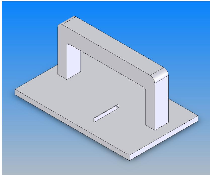
Slika 30. Položaj Hallove sonde kod mjerjenja tangencijalne komponente magnetskog polja dupleks čelika
