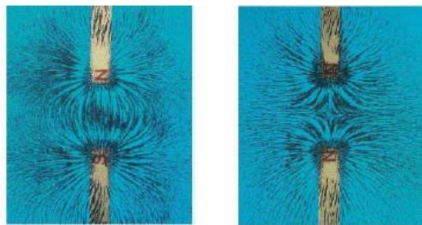
Slika 13. Prikaz magnetskog polja sustava magneta [6]
