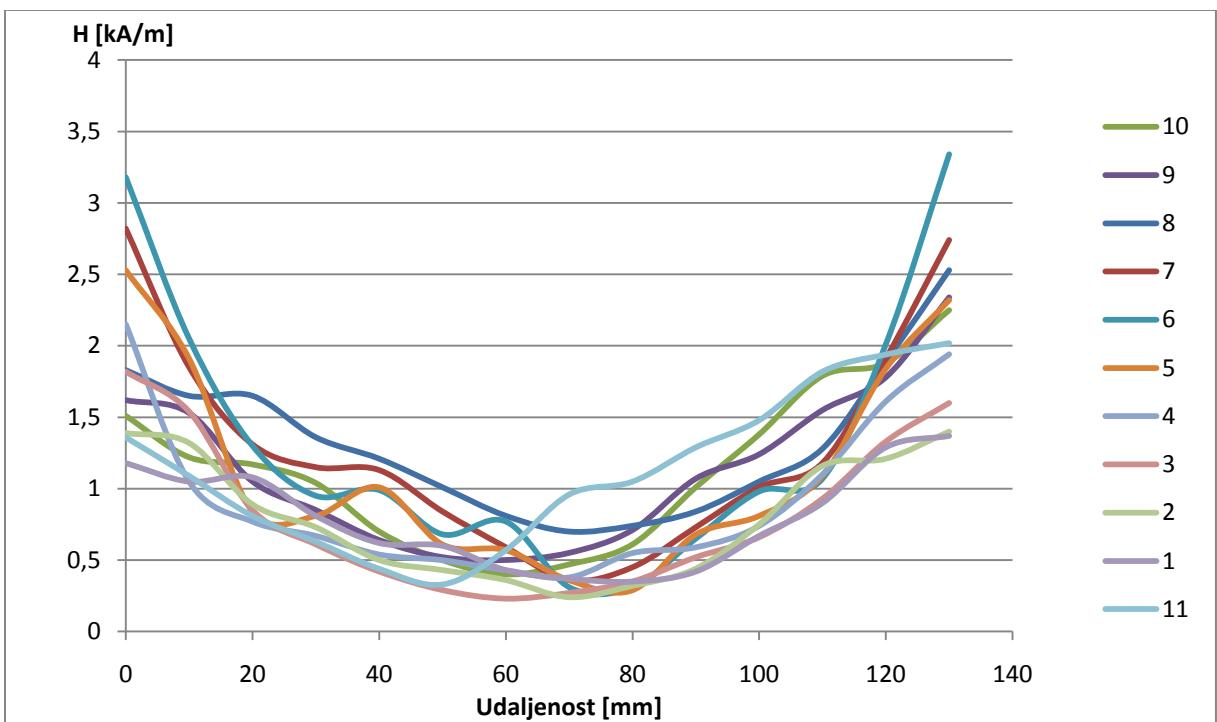
Grafikon 9. Tangencijalna komponenta magnetskog polja konstrukcijskog čelika
