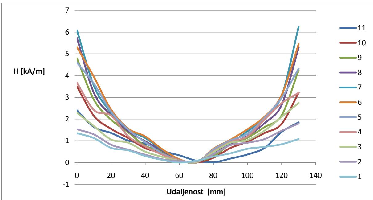
Grafikon 7. Normalna komponenta magnetskog polja konstrukcijskog čelika
