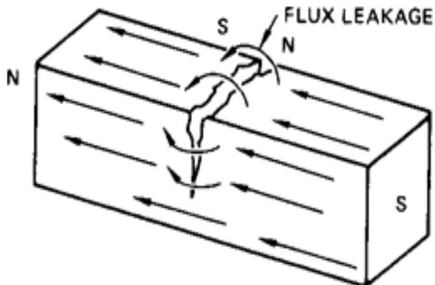
Slika 14. Shema magnetnog ispitivanja [5]
