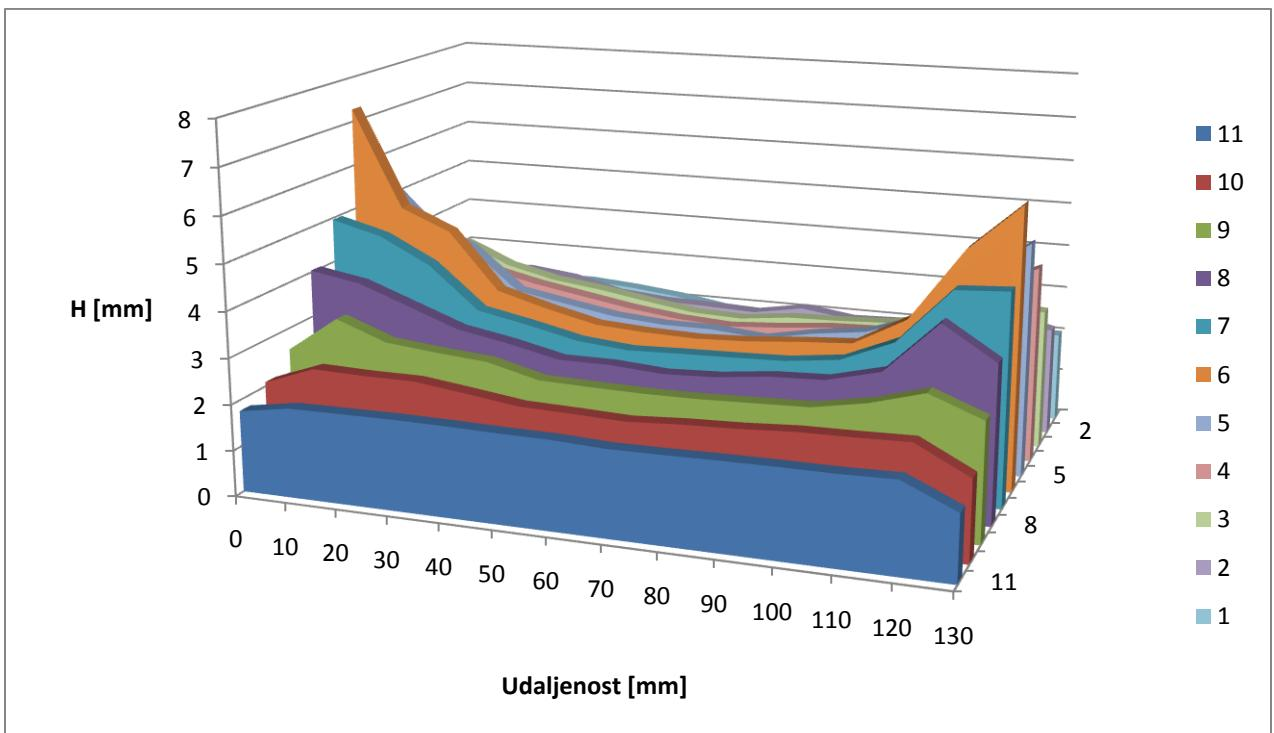
Grafikon 12. 3D prikaz tangencijalna komponenta magnetskog polja konstrukcijskog čelika
