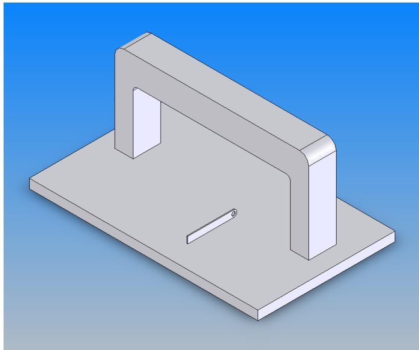
Slika 33. Položaj Hallove sonde kod mjerjenja tangencijalne komponente magnetskog polja konstrukcijskog čelika
