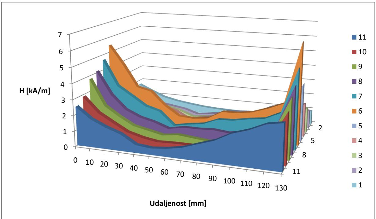
Grafikon 4. 3D prikaz tangencijalne komponente magnetskog polja
