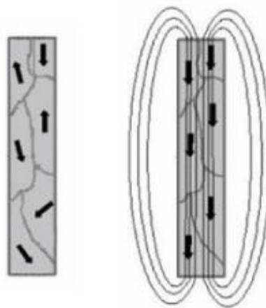
Slika 5. Shematski prikaz usmjerenih elementarnih magneta [8]
