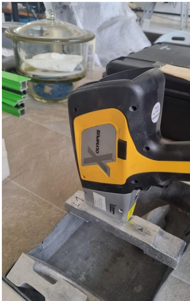
Slika 59 Određivanje kemijskog sastava odljevka XRF metodom
