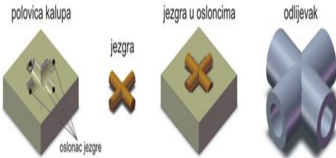
Slika 10 Jezgra, kalup i odljevak [8]
