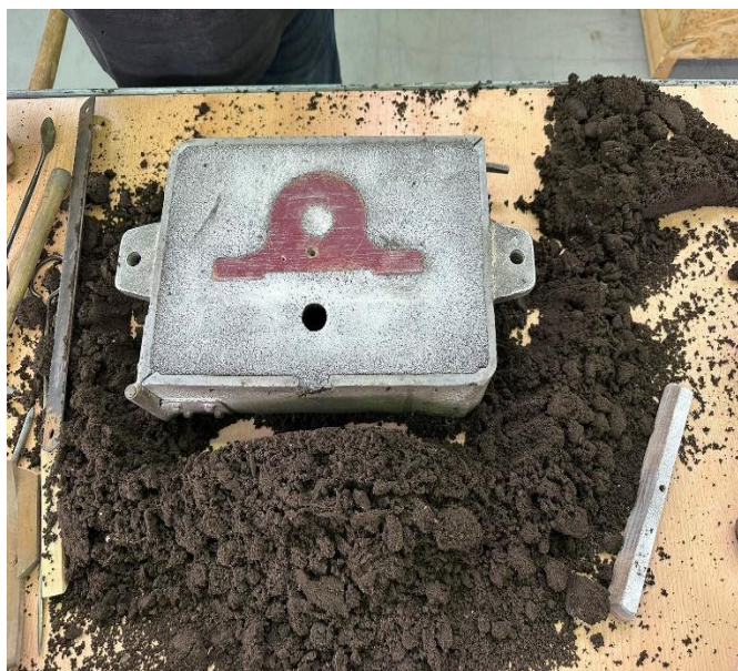
Slika 49 Model odljevka u gornjaku
