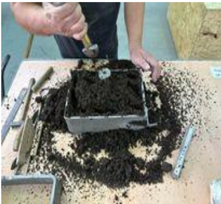
Slika 48 Sabijanje kalupne mješavine
