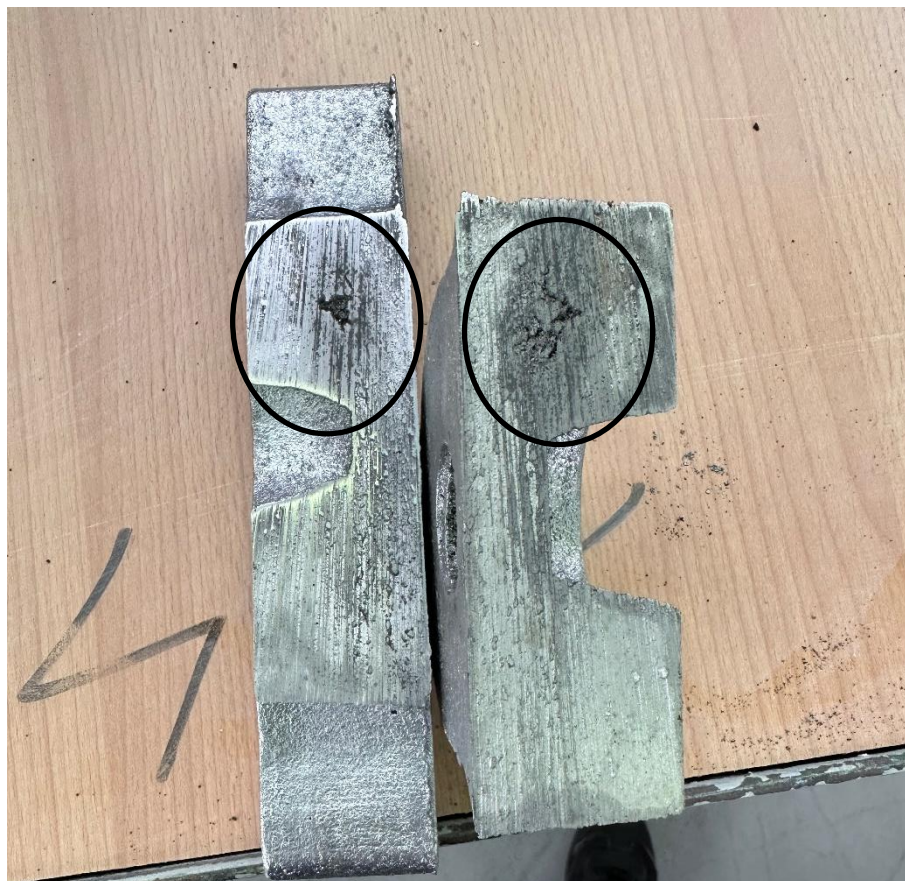
Slika 58 Prikaz poroznosti na odljevku
