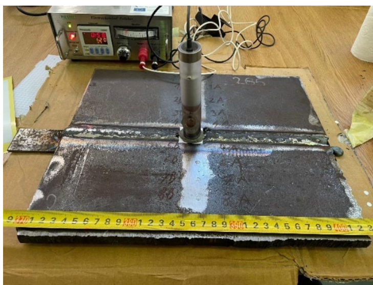
Slika 57. Elektropoliranje nadvišenja zavara
