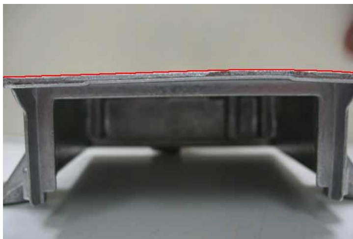
Slika 23. Primjer deformacije odljevka [9]
