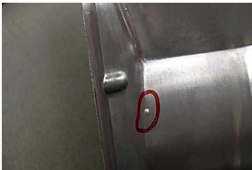
Slika 22. Primjer mjehuravosti površine [9]
