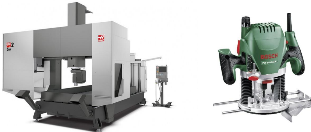
Slika 18. a) Vertikalna CNC glodalica [28]; b) Dvoručna vertikalna glodalica [19]
