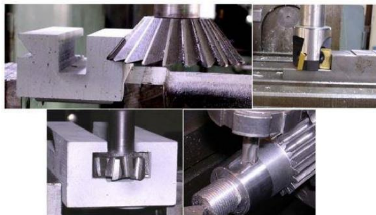
Slika 17. Postupci glodanja vertikalnom glodalicom
