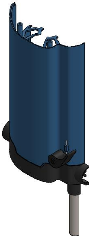
Slika 39. Gornji dio vertikalne dvoručne glodalice sa mehanizmom zatezanja vertikalne vodilice
