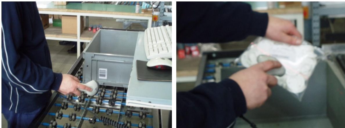
Slika 45. Skeniranje barkoda spremnika i artikla
