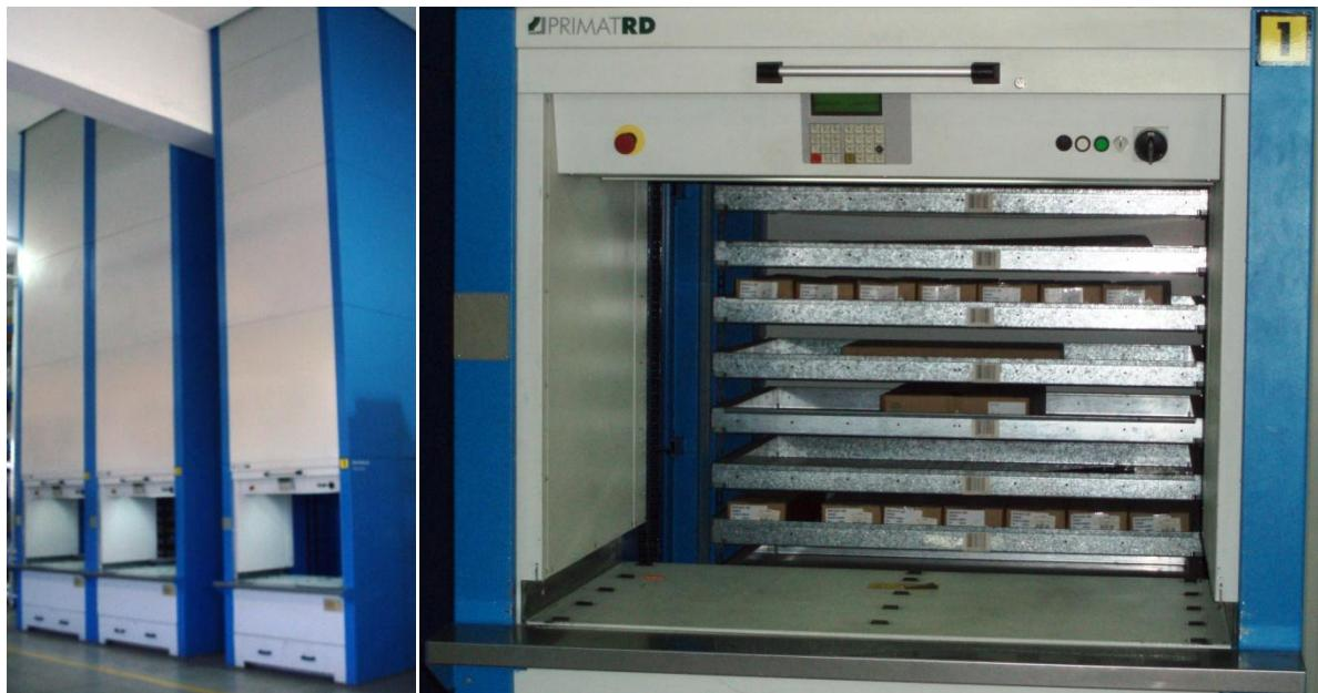
Slika 30. VLM-Vertikalni podizni moduli
