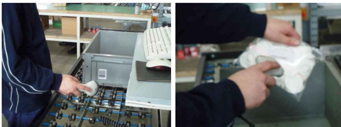
Slika 45. Skeniranje barkoda spremnika i artikla
