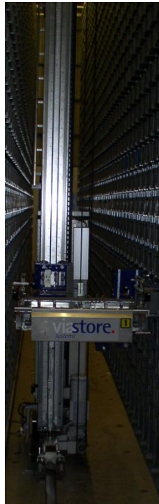
Slika 31. Automatizirana dizalica Viastore
