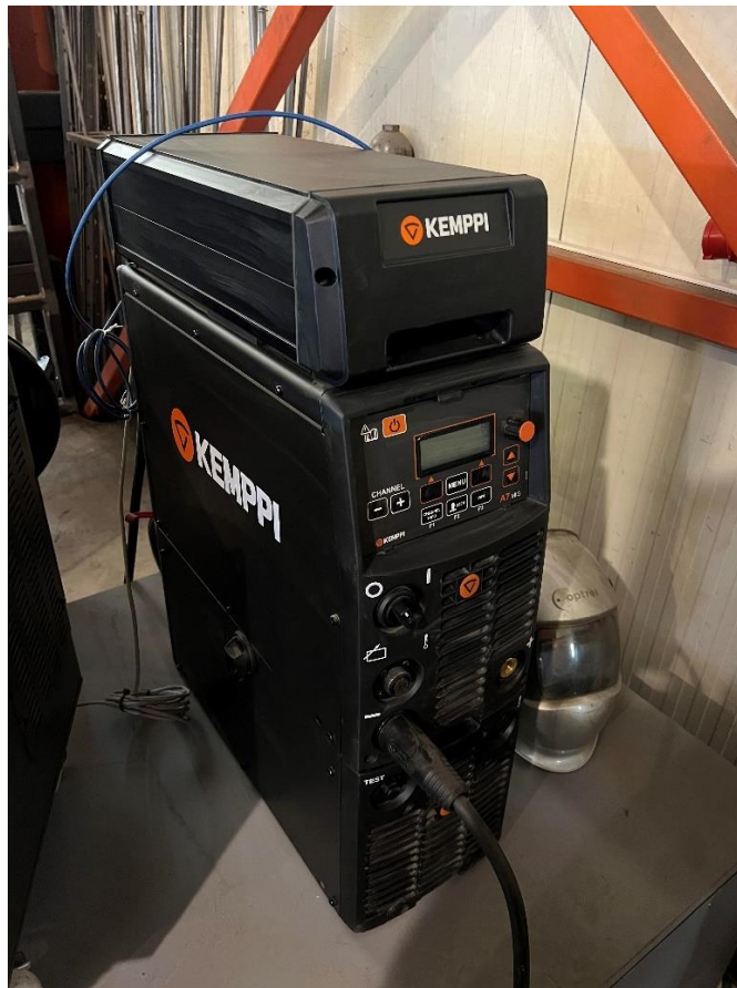
Slika 20. A7 MIG izvor struje s ugrađenom jedinicom za robotsko sučelje na vrhu
