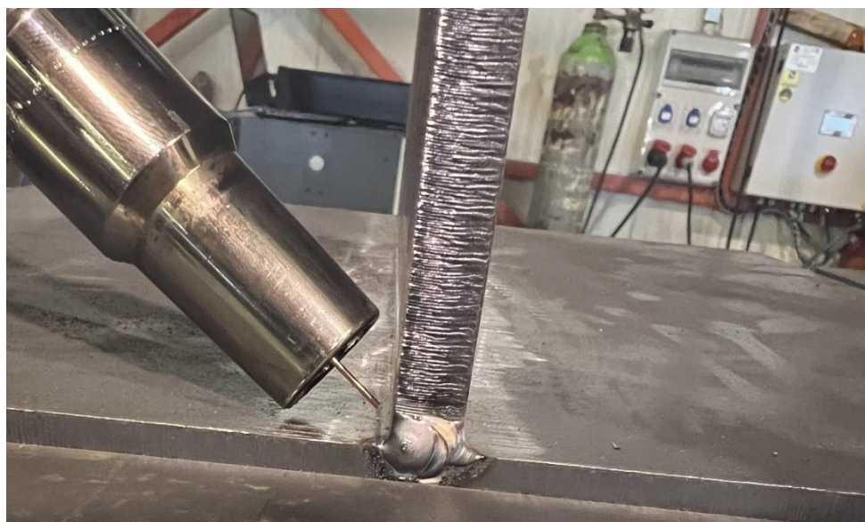
Slika 29. Pozicija pištolja u krajnjoj točki zavora
