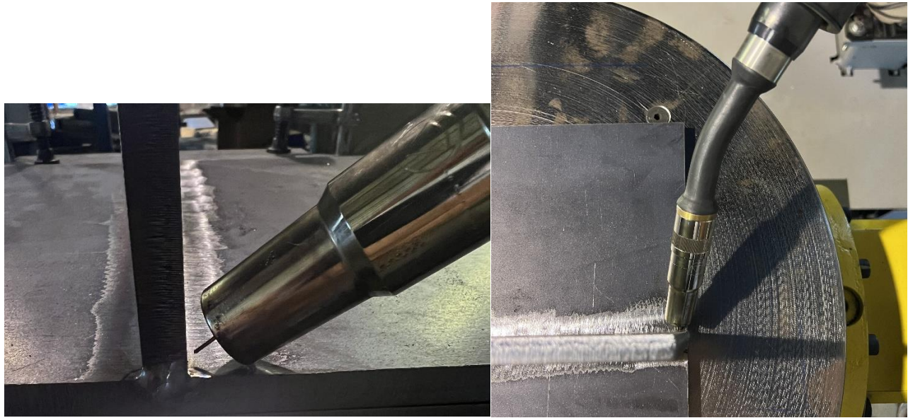
Slika 28. Pozicija vrha žice i pištolja kod zavora
