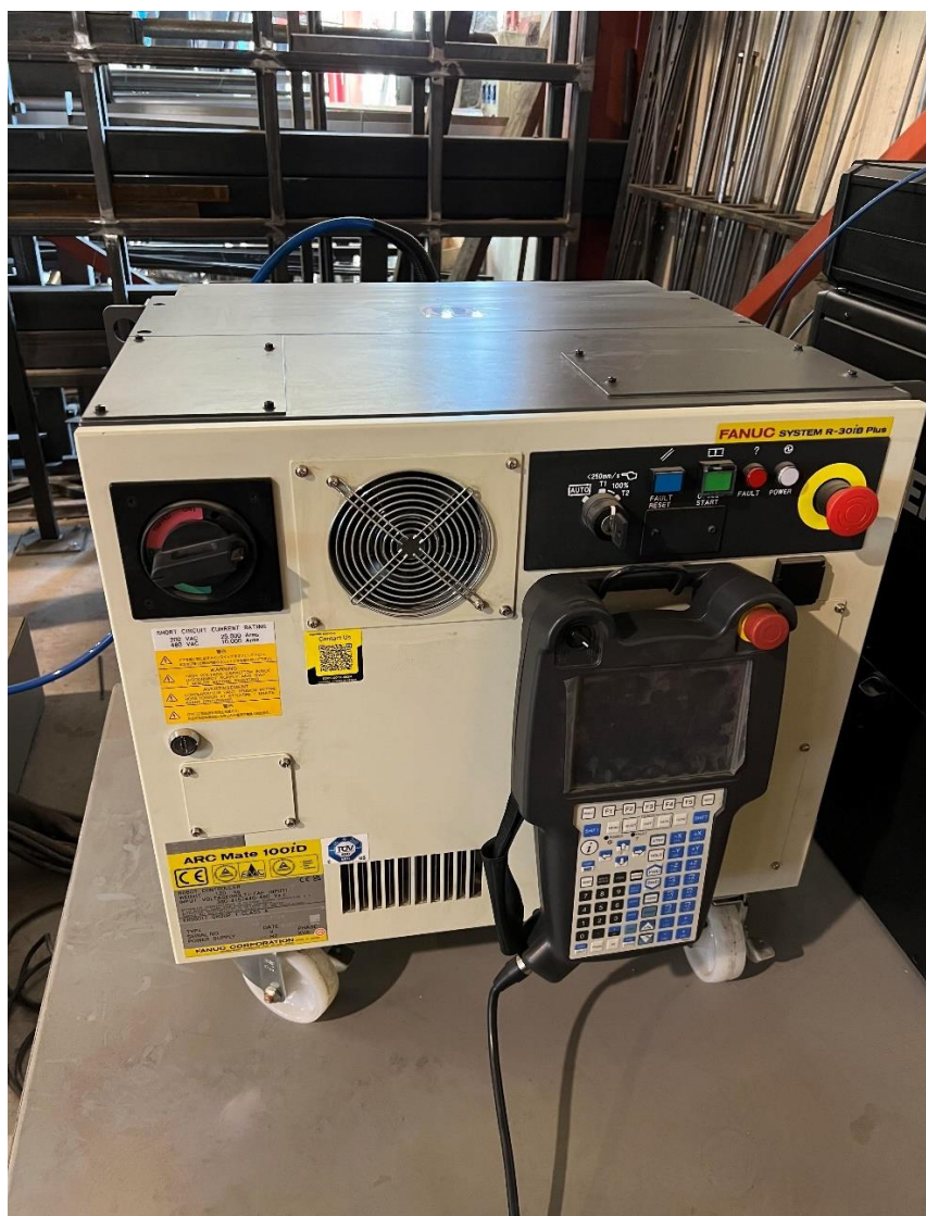
Slika 22. Upravljačka jedinica s kontrolerom
