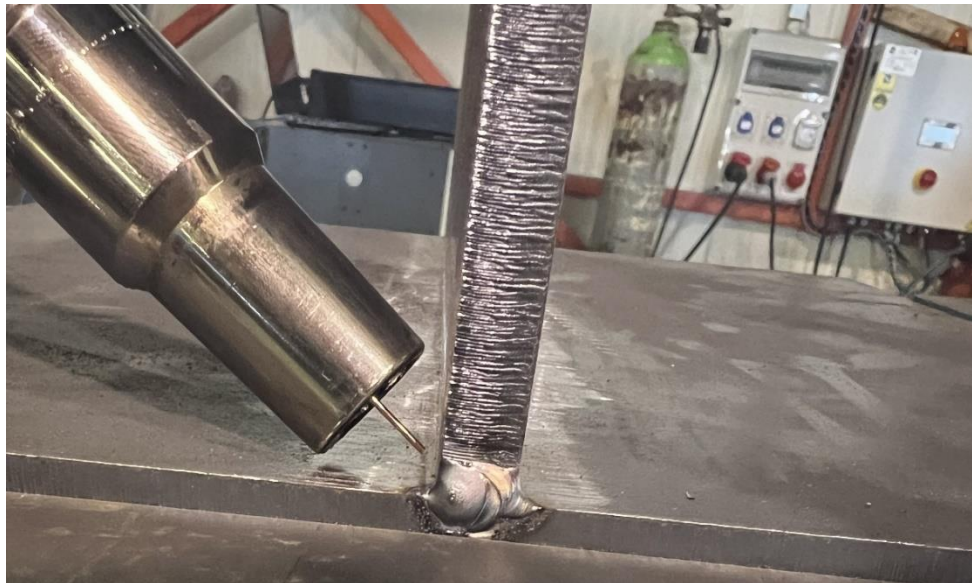
Slika 29. Pozicija pištolja u krajnjoj točki zavora
