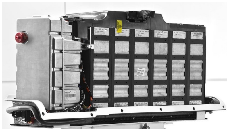
Slika 23. McLaren P1 baterijski paket (preuzeto iz [22]).
