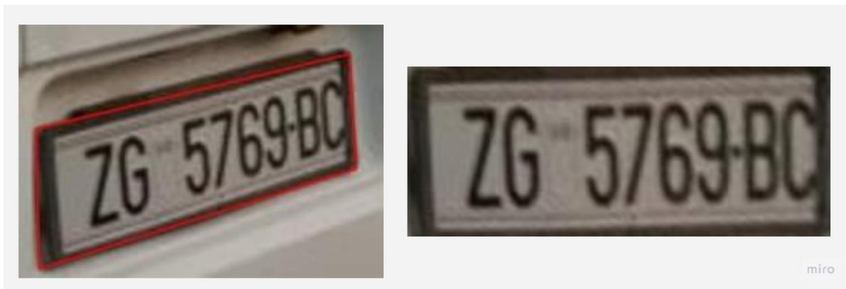
Slika 47. Transformacija na temelju četiri točke (engl. four point transform )
