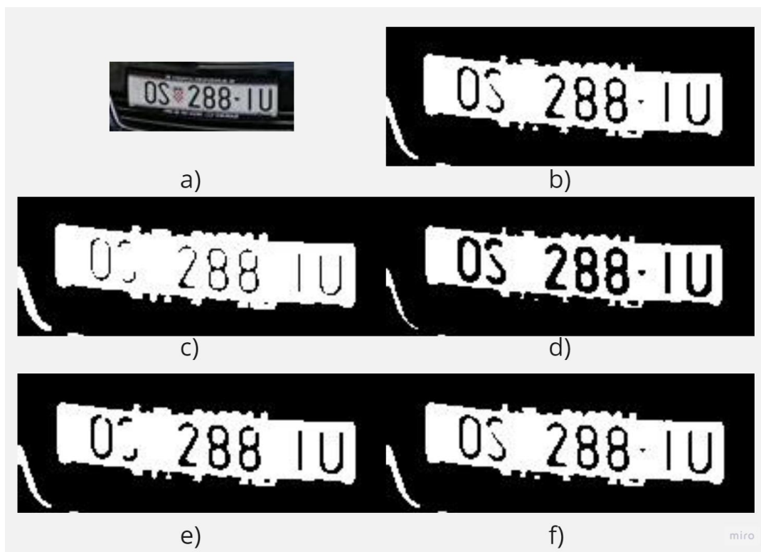
Slika 46. Koraci u predobradi registrarske pločice: a) originalna slika 103×39 piksela, b) povećana, zamućena i binarizirana slika u sivim nijansama, c) dilatacija, d) erozija, e) zatvaranje, odnosno dilatacija pa erozija, f) otvaranje, odnosno erozija pa dilatacija
