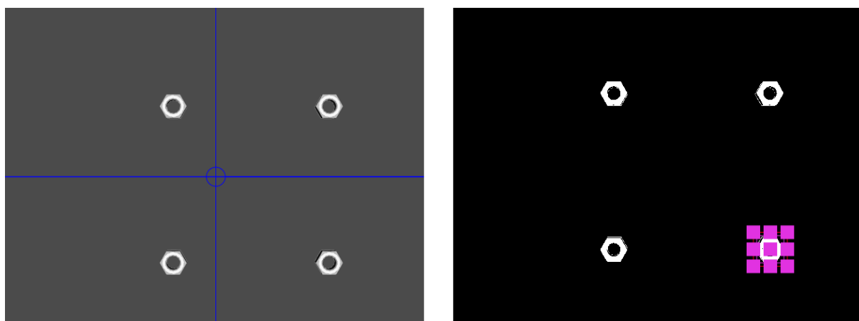
Slika 18. Pogled kamere prije segmentacije (lijevo) i nakon (desno)
