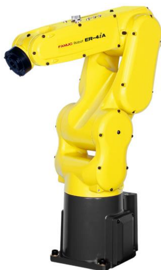
Slika 45. Robot FANUC ER-4iA (lijevo), kamera i objektiv (desno)
