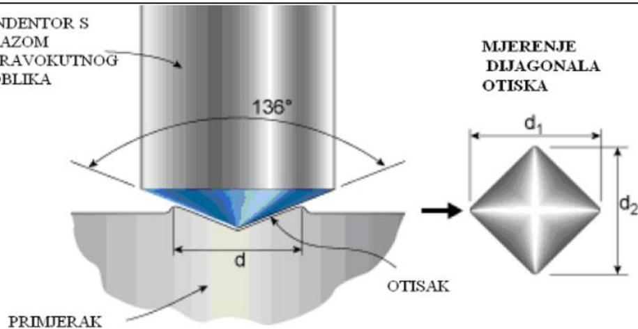
**Slika 29. Prikaz mjerenja tvrdoće Vickersovom metodom [35]**
