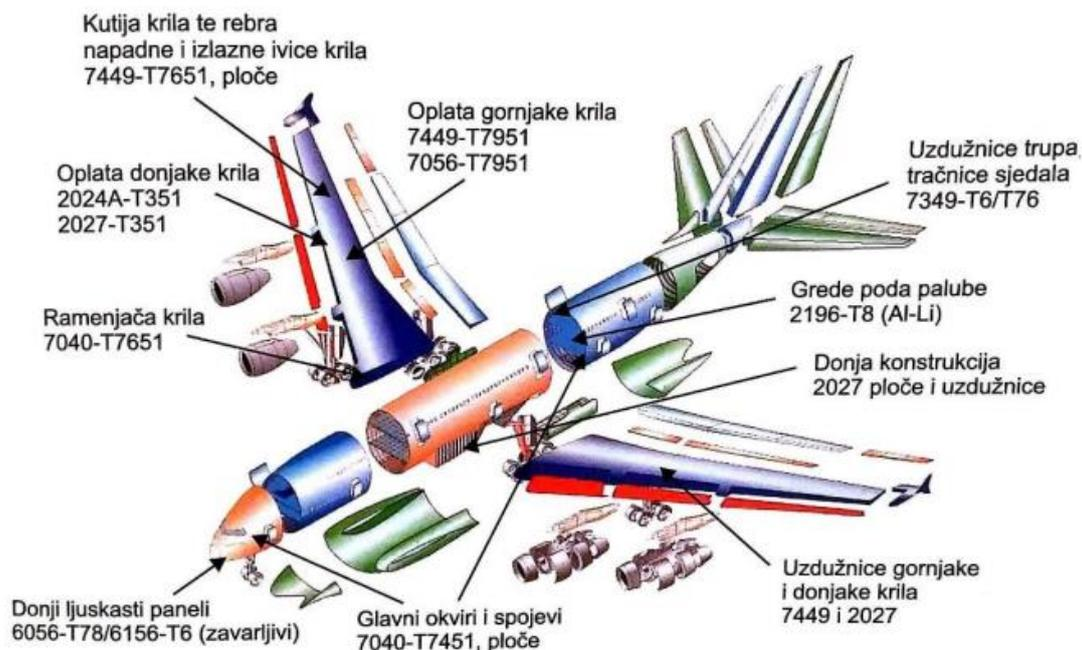
**Slika 18. Primjena Al-legura u zrakoplovu Airbus A380-800 [19]**
