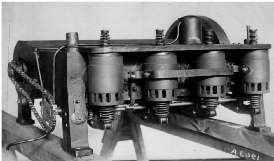
Slika 1. Motor braće Wright iz 1903. izrađen od aluminijske legure AlCu9 [2]
