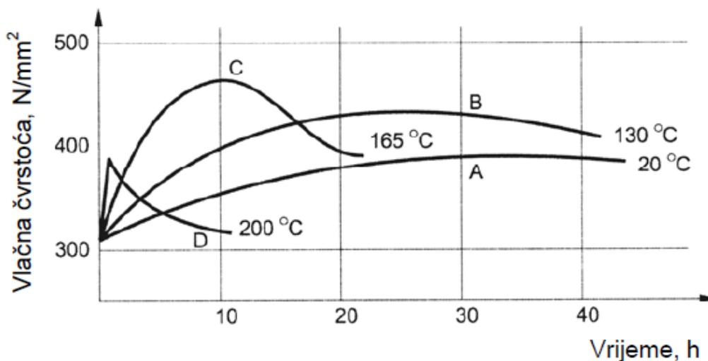
Slika 15. Ovisnost čvrstoće o temperaturi i vremenu dozrijevanja [7]
