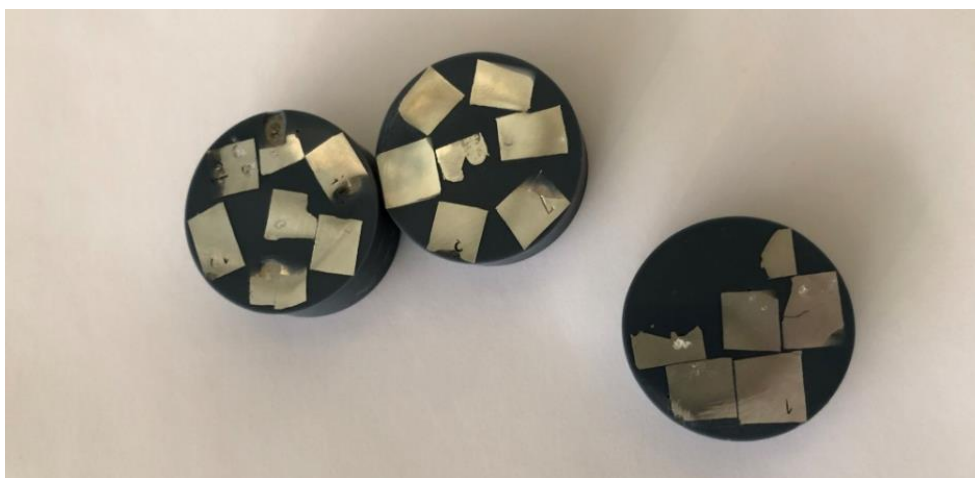
Slika 27. Uzorci spremni za mjerenje tvrdoće
