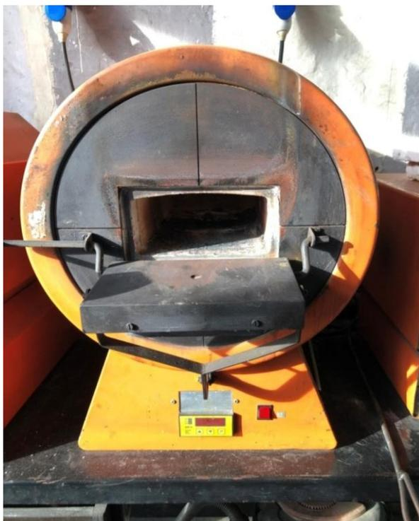
**Slika 25. Labaratorijska elektrootporna peč**
