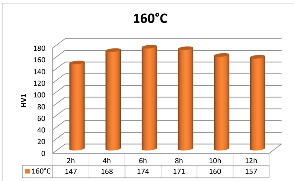
Slika 33. Vrijednosti tvrdoće uzoraka HV1 dozrijevanih na 160°C pri različitom trajanju dozrijevanja
