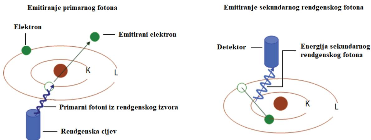
Slika 22. Princip rada XRF uređaja [33]
