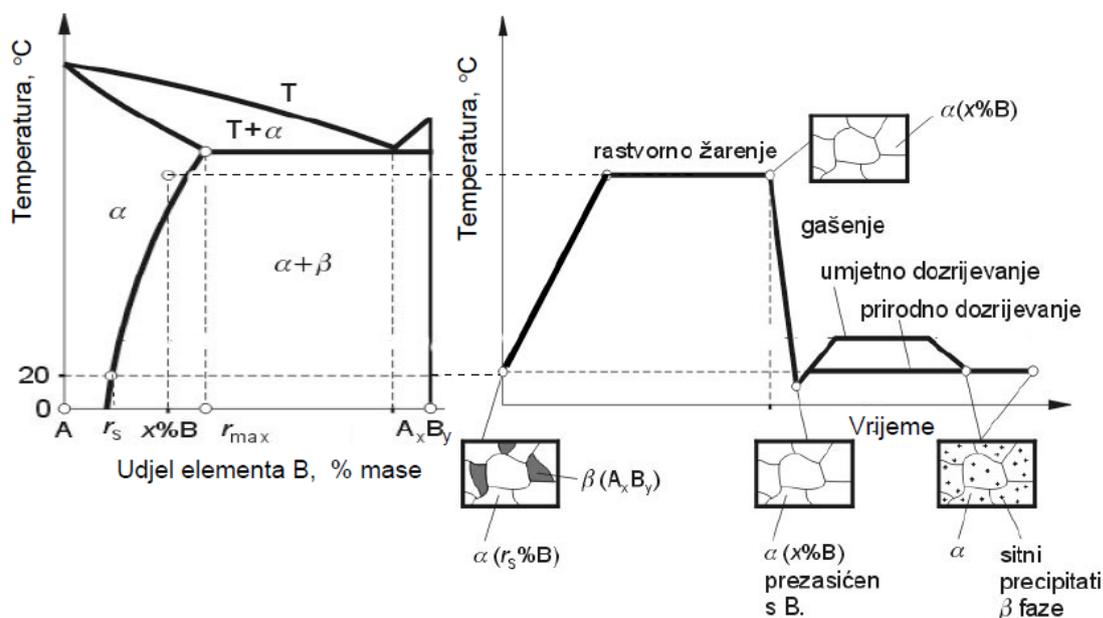
Slika 13. Prikaz općeg dijagrama stanja i postupka precipitacijskog očvršćivanja [7]
