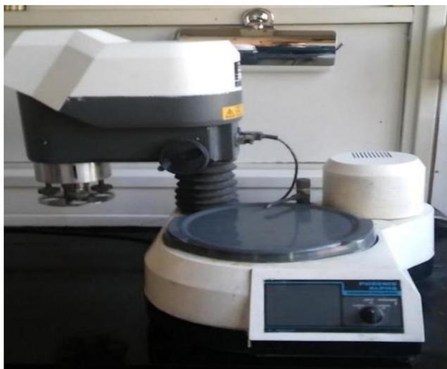
**Slika 28.** Uređaj za brušenje Buehler, Phoenix alpha-grinder/polisher
