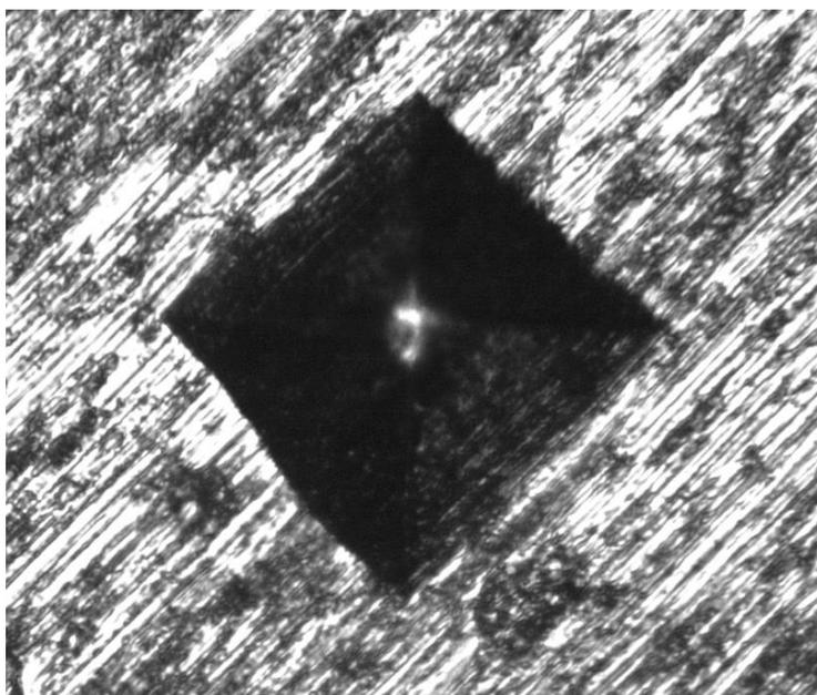
**Slika 31. Otisak penetratora pod mikroskopom**
