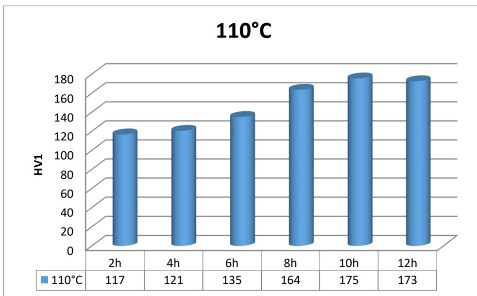
Slika 32. Vrijednosti tvrdoće uzoraka HV1 dozrijevanih na 110°C pri različitom trajanju dozrijevanja
