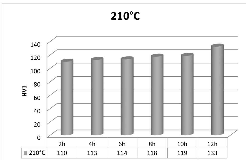
Slika 34. Vrijednosti tvrdoće uzoraka HV1 dozrijevanih na 210 °C pri različitom trajanju dozrijevanja
