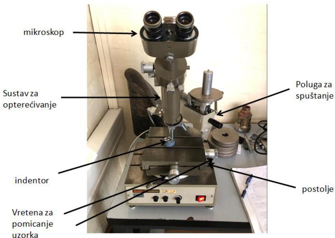
Slika 30. Tvrdomjer ZwickRoellMaterialprüfung
