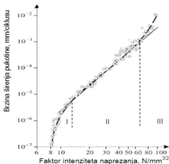
Slika 6. Utjecaj faktora intenziteta naprezanja na brzinu širenja pukotine [7]
