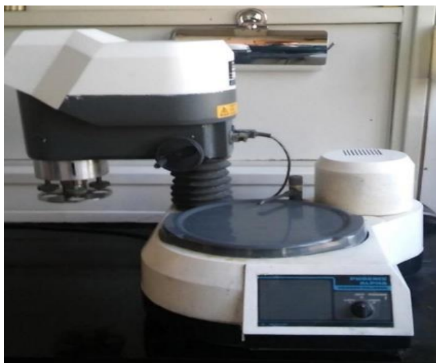
Slika 28. Uređaj za brušenje Buehler, Phoenix alpha-grinder/polisher
