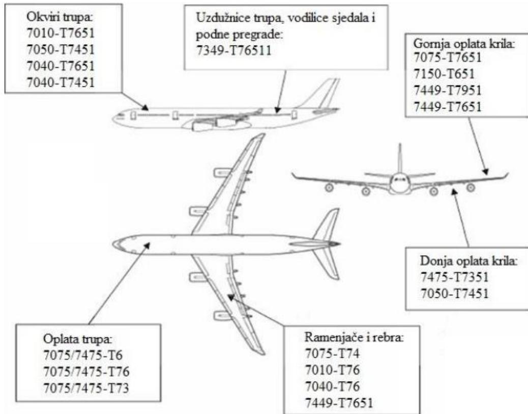
**Slika 17. Primjena pojedinih konstruktala u zrakoplovnim konstrukcijama [19]**
