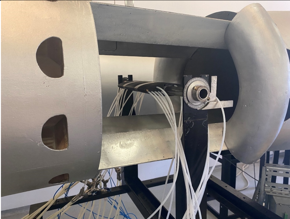
Slika 4-24. Instalirani model u aerotunelu
