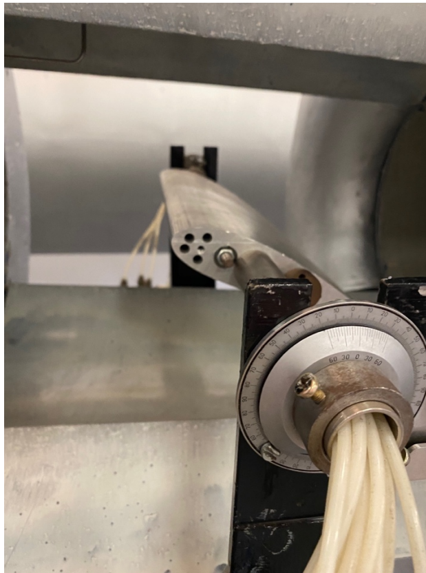
Slika 4-1 Radna sekcija sa već postojećim aeroprofilom
