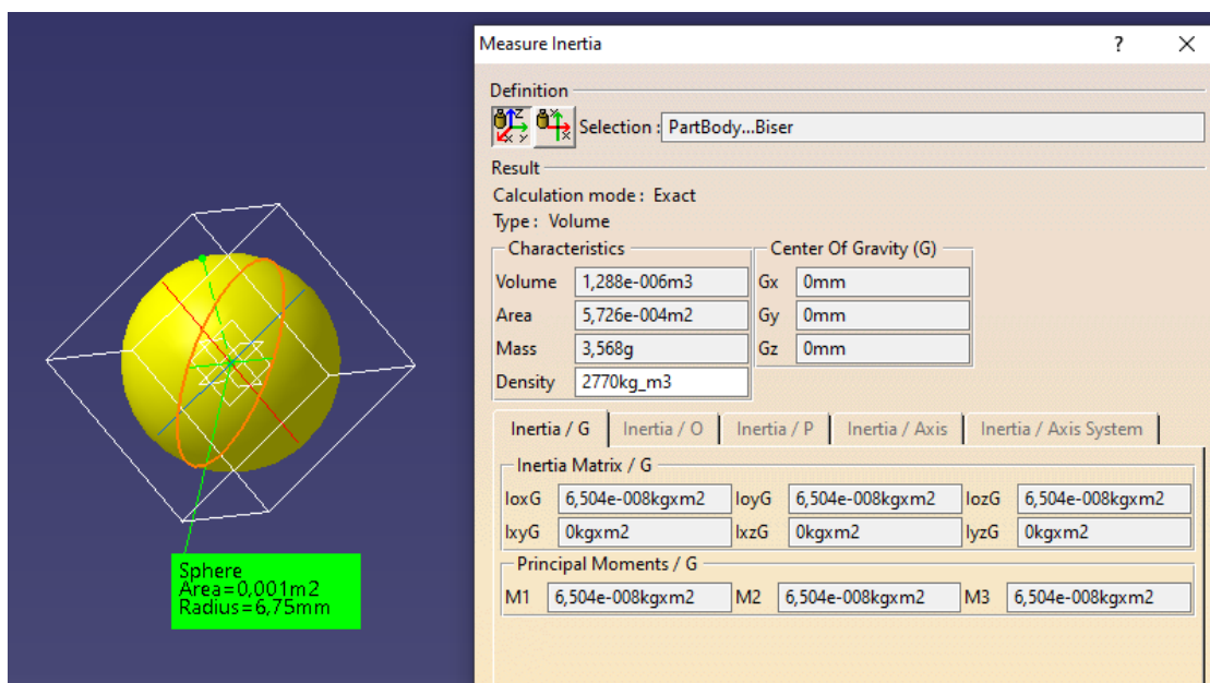
Slika 11. Model bisera i njegove specifikacije u CATIA V5
