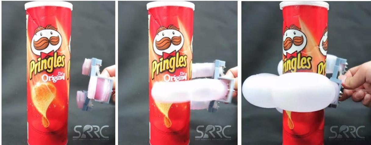
Slika 52. Princip hvatanja Miura hvataljkom [21]
