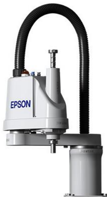
Slika 2.3. Epson LS3-B SCARA [4]
