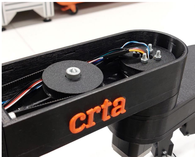
Slika 3.13. Ožičenje ruke SCARA robota
