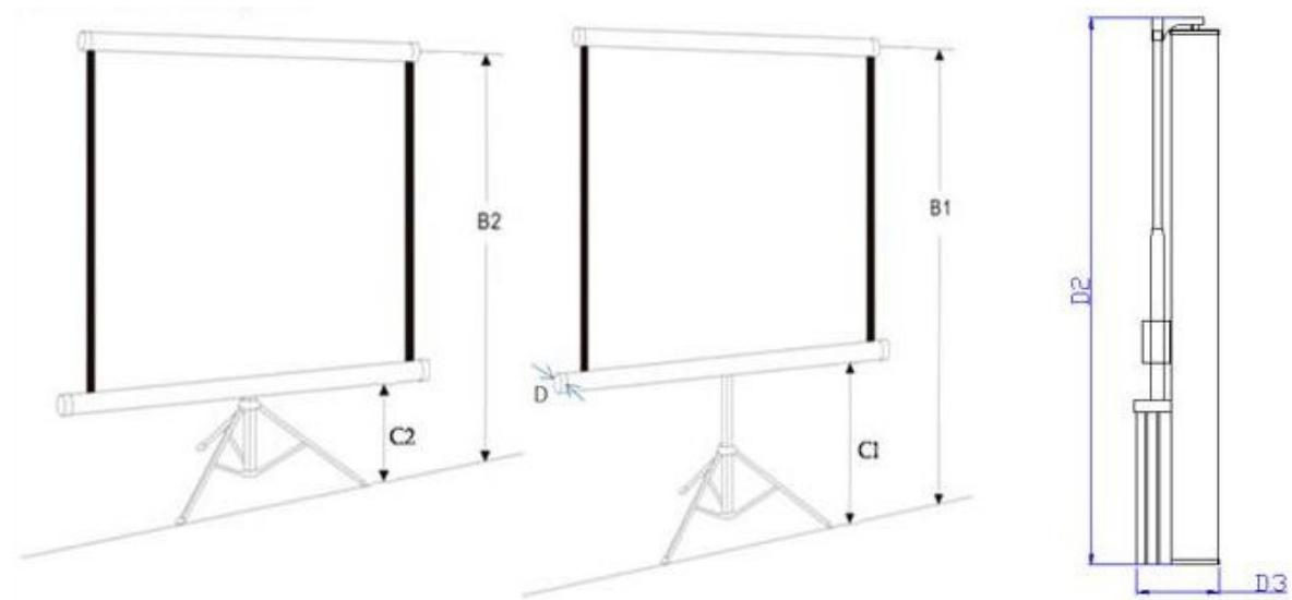
Slika 3.1.5. Prikaz dimenzija „Tripod“ stalka za platno projektor-a
