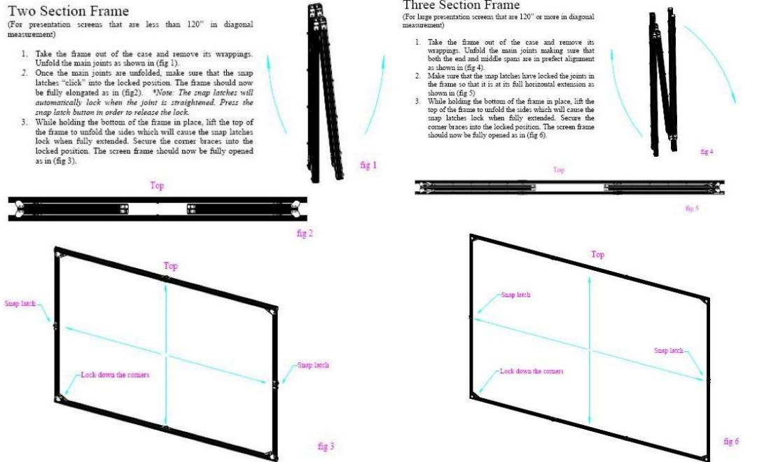
Slika 3.1.12. Prikaz dijelova dvodijelne i trodijelne varijante proizvoda „QuickStand“
