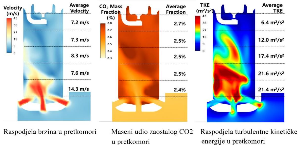
**Slika 24. Raspodjela brzina smjese, maseni udio zaostalog CO<sub>2</sub> te raspodjela turbulentne kinetičke energije za određene geometrijske parametre**
