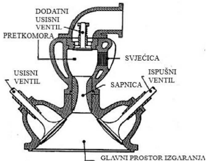
**Slika 1. Koncept Ottovog motora s pretkomorom
