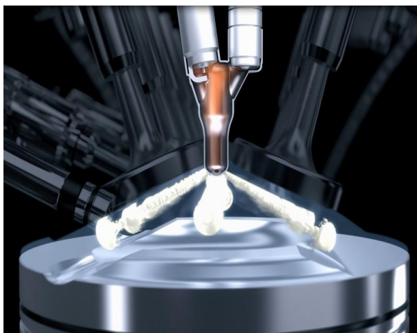
Slika 7. Aktivna pretkomora tvrtke MAHLE Powertrain [10]
