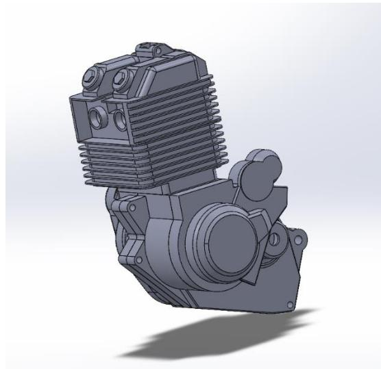
Slika 9. 3D CAD model motora Yamaha XT 600E
