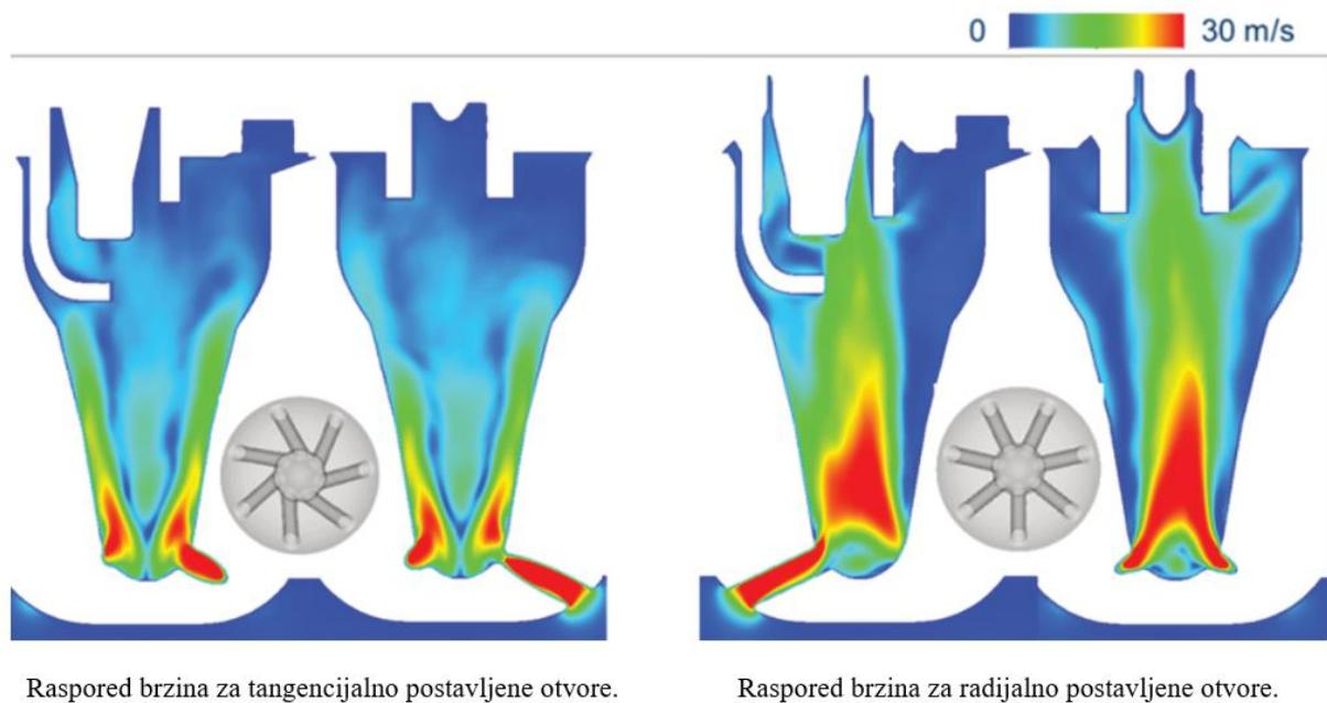
Raspored brzina za tangencijalno postavljene otvore.
