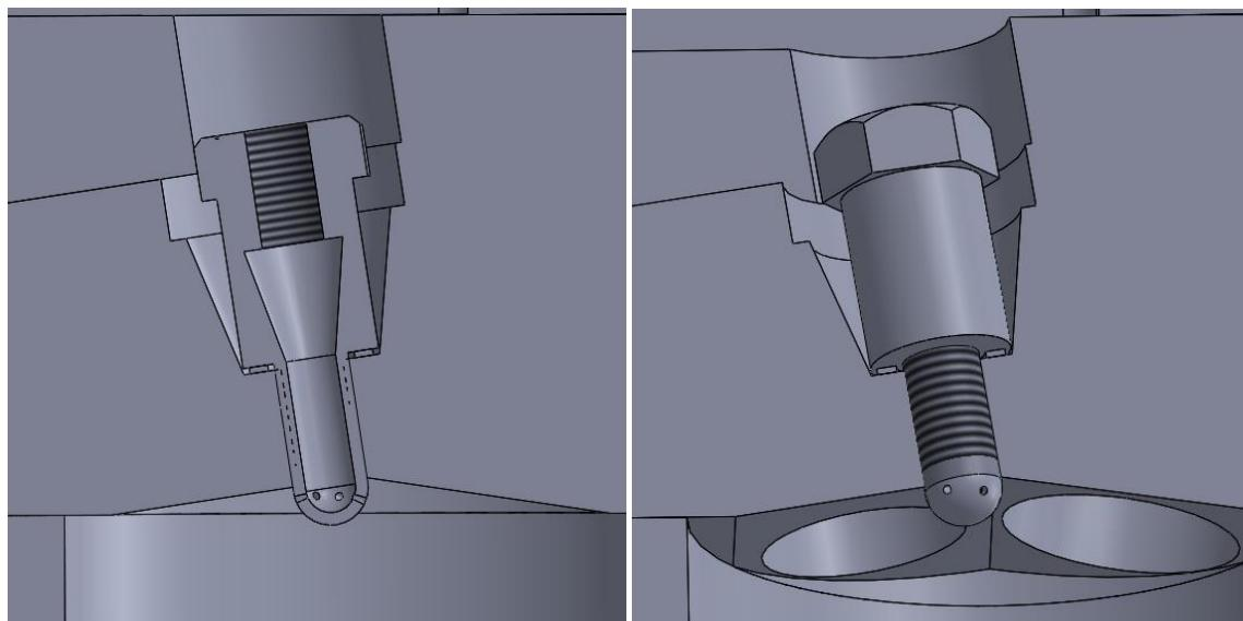
Slika 25. Prikaz pasivne komore u glavi motora
