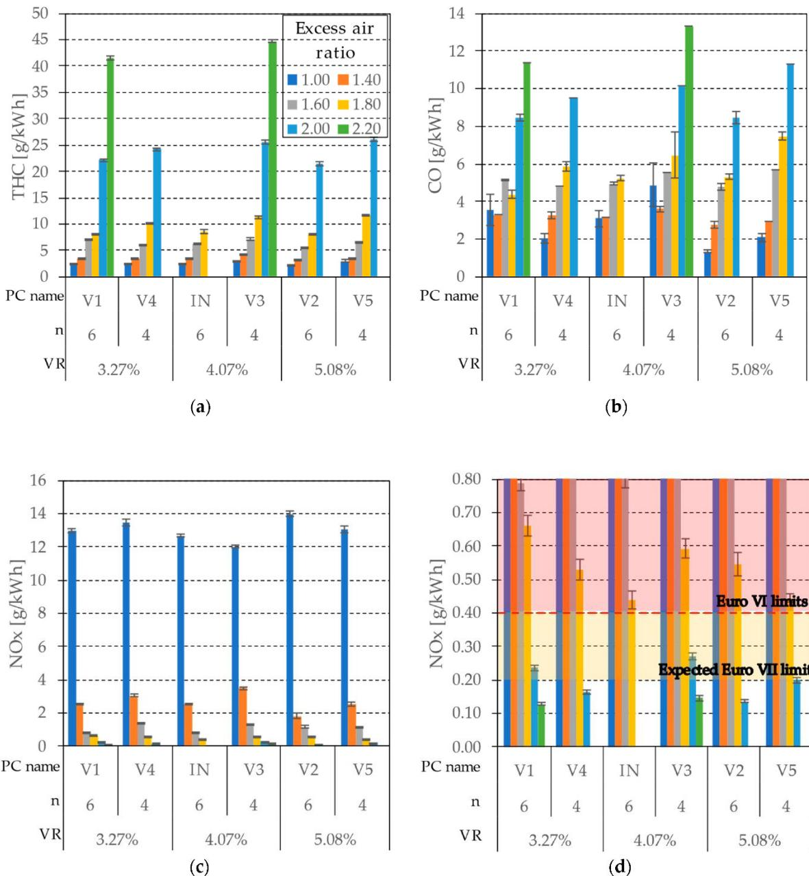
**Slika 18. Utjecaj volumnog omjera pretkomore i broja otvora sapnice na emisije ispušnih plinova: a)THC, b)CO, c)NOx, d)NOx ograničen europskim standardom EURO [14]**
