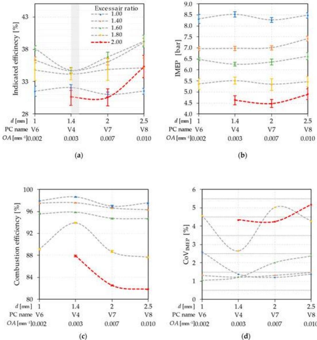
Slika 20. Utjecaj promjera otvora sapnica na performanse motora: a) učinkovitost, b) indicirani srednji efektivni tlak, c) učinkovitost izgaranja, d) stabilnost izgaranja [14]
