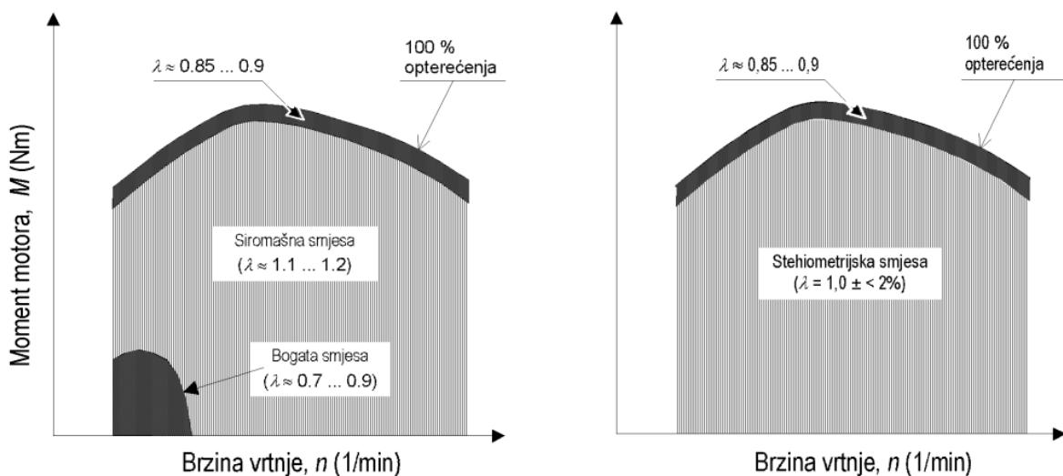
**Slika 11. Faktor zraka  $\lambda$  u radnom području Ottovog motora. Lijevo: motor s rasplinjačem. Desno: uobičajeni motor s ubrizgavanjem benzina u usisnu cijev ili motor s izravnim ubrizgavanjem u cilindar i homogenom smjesom. [3]**
