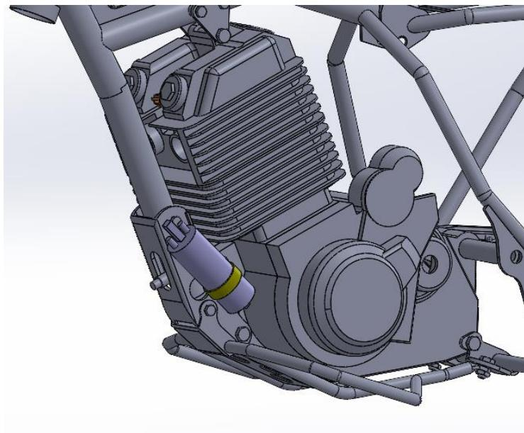
**Slika 14. Pozicija visokotlačne pumpe goriva na okviru motocikla**
