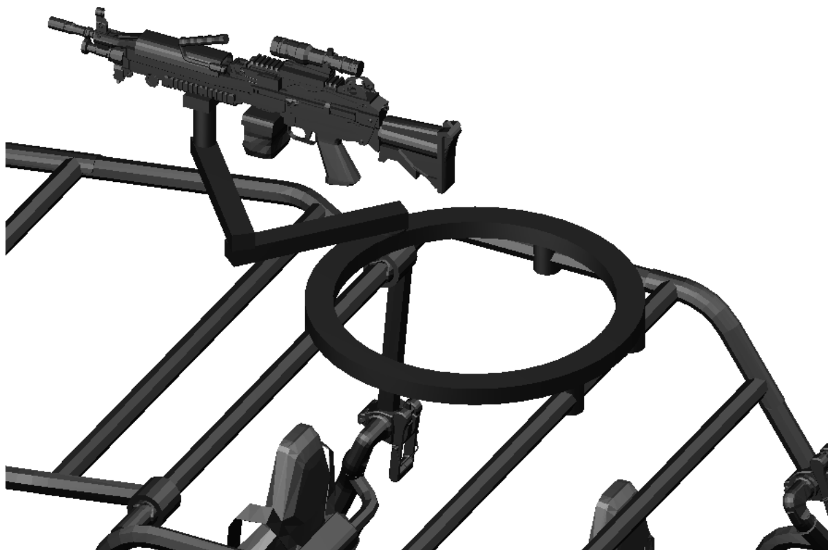
Slika 20: Model okretnog postolja strojnice
