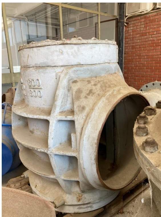
Slika 1. Reparirani cilindrični ventil – slikano na izvršavanju industrijske prakse u HEP – Toplinarstvu.
