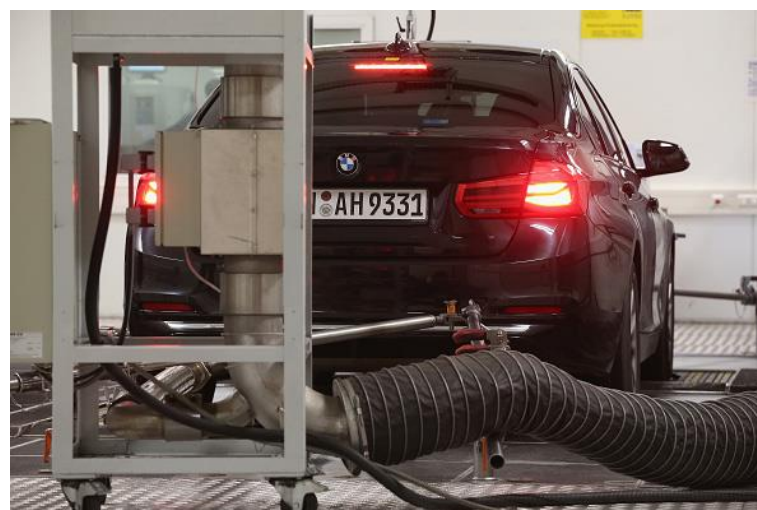
Slika 1 Određivanje emisije štetnih spojeva WLTC-ciklusom [2]
