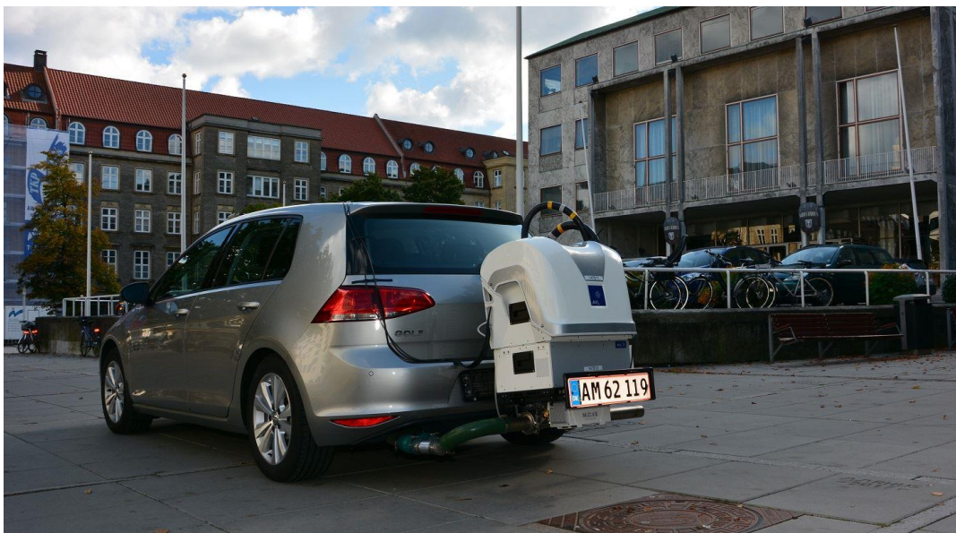
Slika 3 PEMS uređaj montiran na kuku automobila [4]
