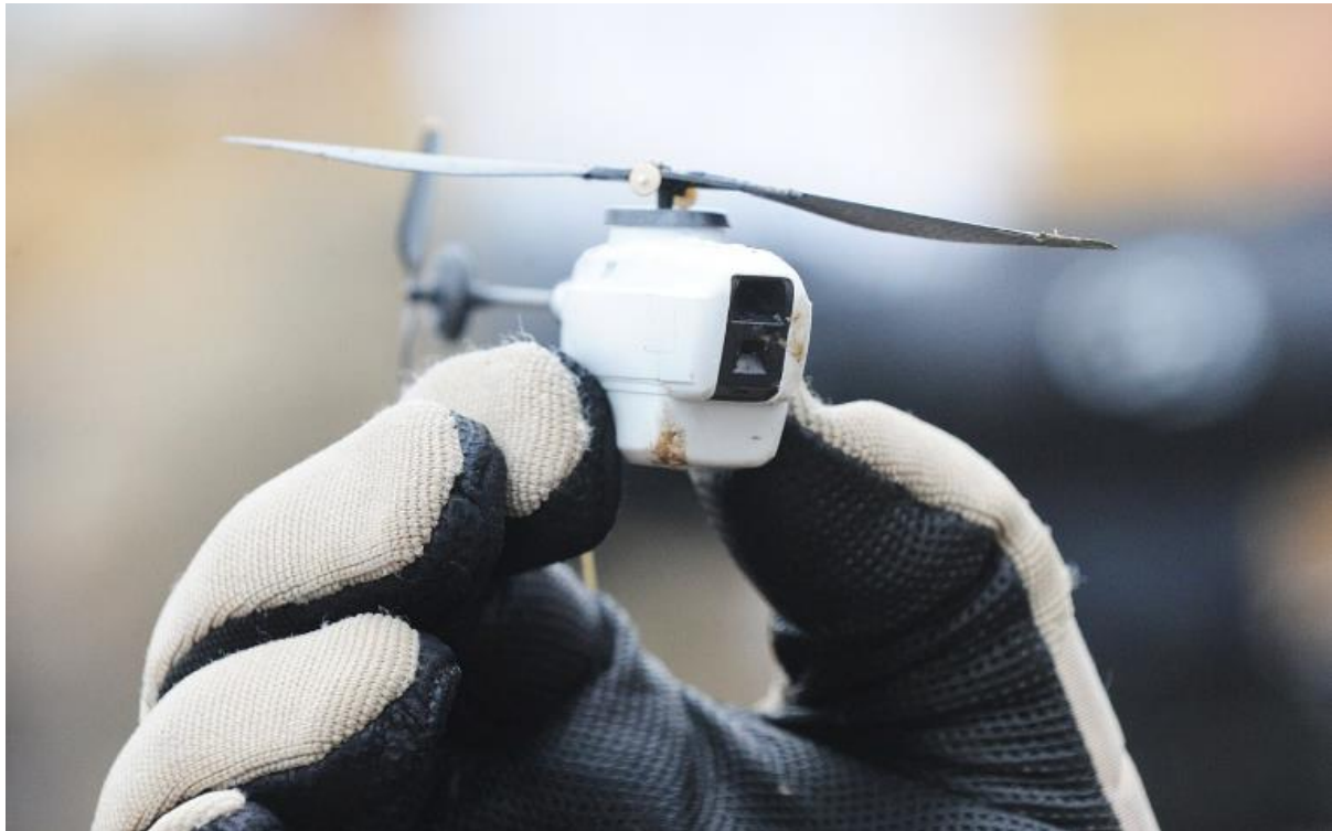
Slika 14. Dron Black hornet nano [25]
