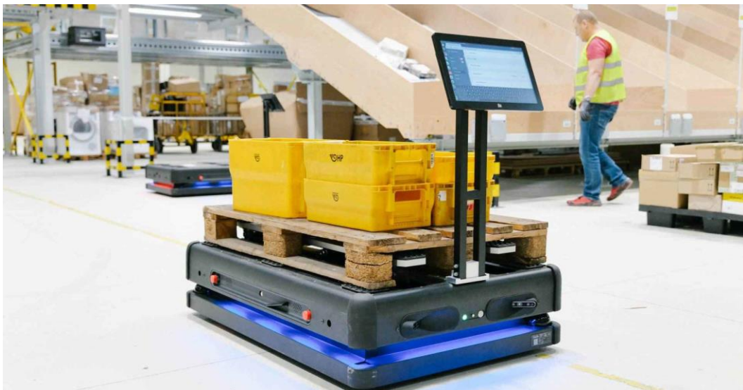
Slika 1. Mobilni autonomni robot za prijevoz paleta [1]
