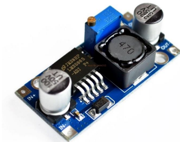
Slika 15. DC-DC Buck konverter LM2596s [9]
