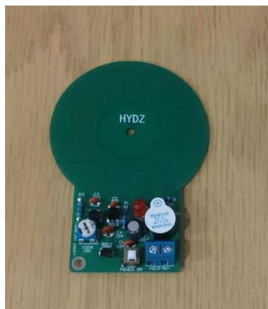
Slika 57. Tiskana pločica senzora metala
