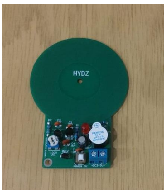
Slika 57. Tiskana pločica senzora metala
