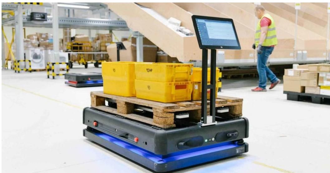
Slika 1. Mobilni autonomni robot za prijevoz paleta [1]
